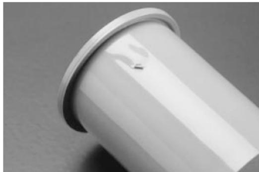
*Fig. 5 : Inclusion d'air en surface [KRA 00]*
