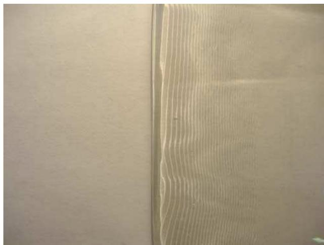
**Fig. 86 : Défaut en surface de la pièce généré par l'écoulement du polycarbonate dans l'outillage d'injection**
