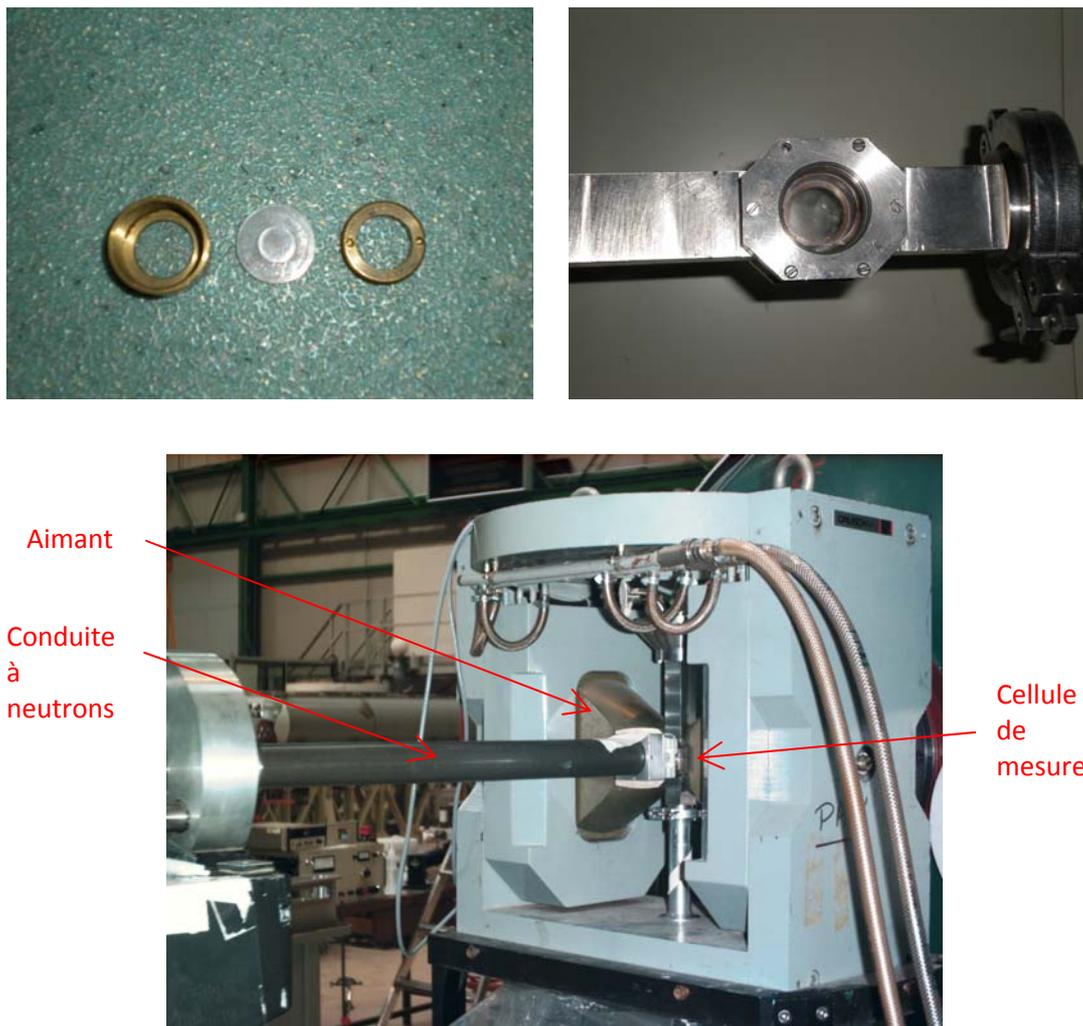
Figure 2.13 : En haut : cellule de mesure et dispositif de chauffage. En bas : échantillon placé au cœur d'un aimant (IT) et monté sur un dispositif de chauffage.
