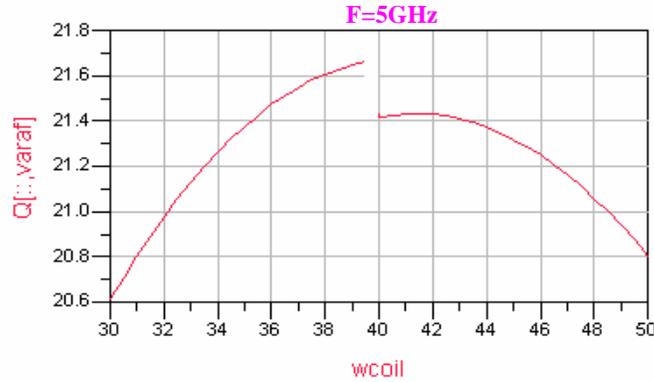
Figure IV-10 Facteur de qualité de l'inductance en fonction de la largeur de ruban métallique
