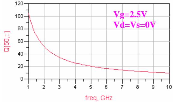
**Figure IV-12** Q(f) des trois varicaps N+Poly/Nwell matriciées
