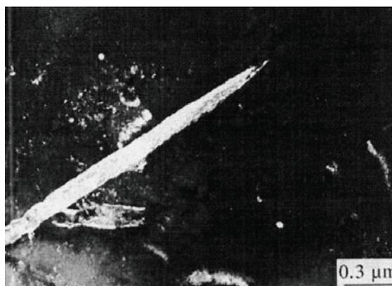
Figure I.9 - Micrographie MET en champ sombre d'un hydrure  $\gamma$  dans un alliage Zr-1Nb [57].
