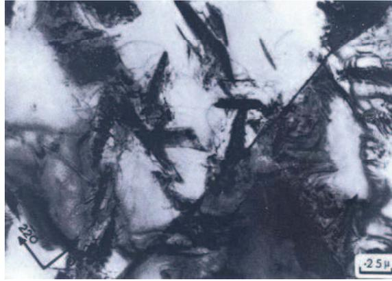
Figure I.15 – Micrographie MET montrant des hydrures intragranulaires invisibles au microscope optique et au MEB dans le zirconium pur [58].
