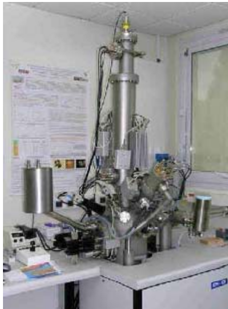
Figure 13 : Spectromètre de Masse SIMS à temps de vol : ToF-SIMS (ICSN, Gif-sur-Yvette, France)
