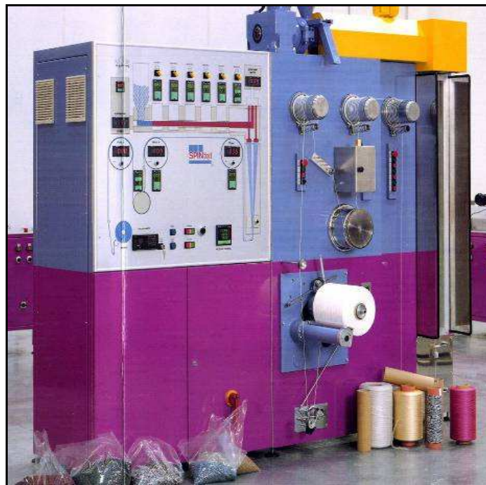
Figure C.1 Pilote de filage en voie fondue Spinboy I
