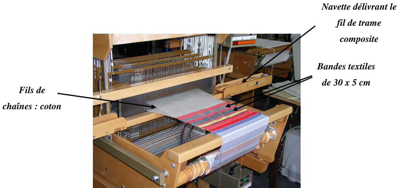
Figure E.3 Insertion en trame du fil conducteur pour la réalisation de bandes textiles
