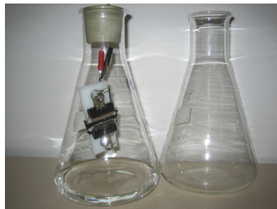
Figure E.9 Système de détection de vapeurs de solvant en mode statique (UBS)
