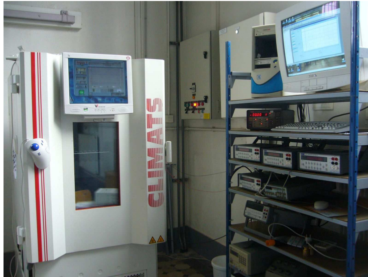
Figure E.8 Enceinte climatique reliée au multimètre Keithley et au programme informatique contrôlant l'humidité relative
