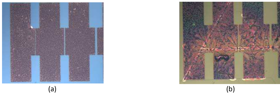
Figure III.3 : Images au microscope optique d'une échelle TLM de contacts ohmiques réalisés sur AlN déposé sur Si(111) et Si(100), respectivement A801 (a) et A834 (b).
