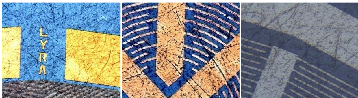
Figure III.33 : Lithographie optique et métallisation sur MSM diamant autoporté de test (260 \mu m d'épaisseur).
