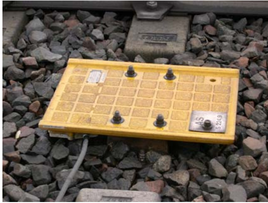
Fig. 1. 1. Balise KVB fixée sur la voie ( www.lebmodelisme.com )
