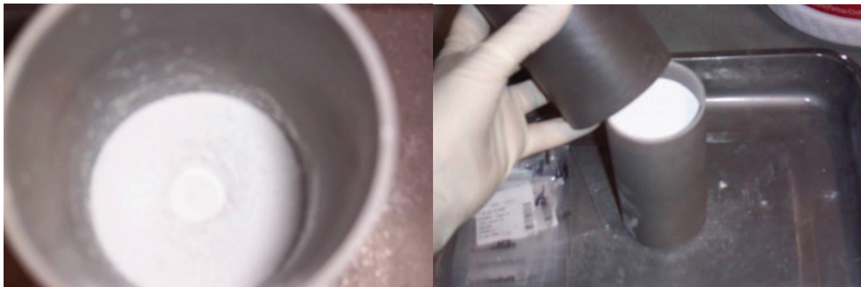
Figure II-8 : Appareillage pressage isostatique à chaud - Creusets internes en alumine accueillant les échantillons entourés d'un lit de poudre'
