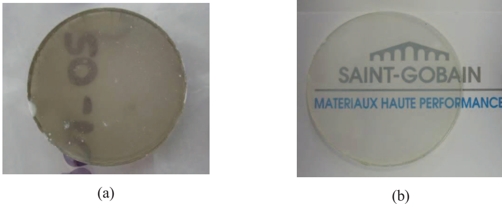
Figure IV-4 : Vue d'un échantillon (a) pur après « HIP » et (b) après recuit, rectification et polissage.
