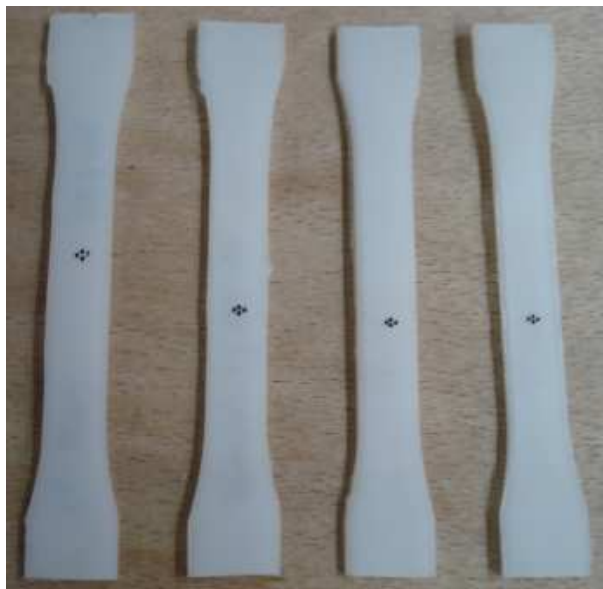
(a) Éprouvettes EPDM/PP avec 4 marqueurs
