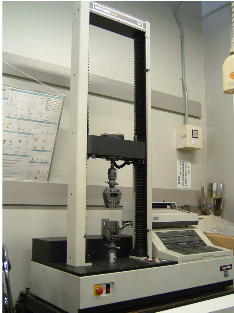
FIGURE II.5 - Machine d'essais du type INSTRON 4302.
