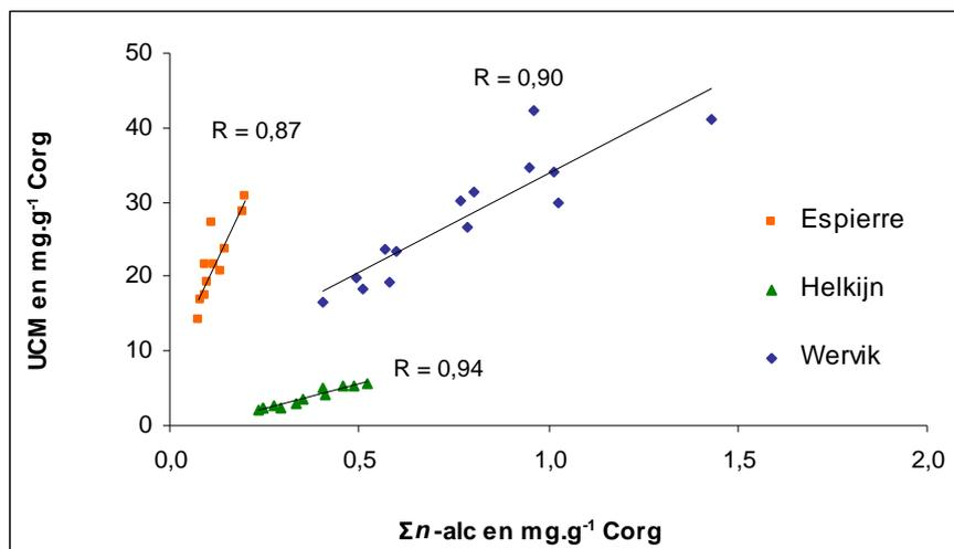
**Figure 3.9.** Droites et coefficients de corrélations obtenus entre les concentrations de l'UCM (unresolved complex mixture) et les concentrations totales en *n*-alcane ( $\Sigma n\text{-alc}$ ), exprimées en  $\text{mg.g}^{-1}$  de carbone organique (Corg), pour les sites de l'Espierre, d'Helkijn et de Wervik.
