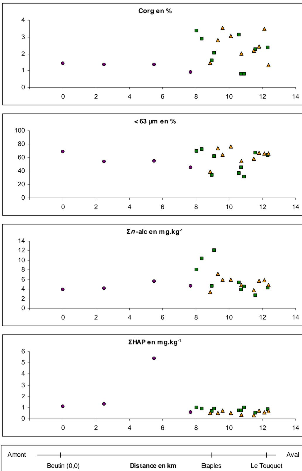
**Figure 3.14.** Distributions longitudinales (en fonction du point kilométrique) de la teneur en carbone organique sédimentaire (en %), de la fraction de particules fines < 63  $\mu\text{m}$  (en %), de la concentration totale en n-alcanes ( $\Sigma n\text{-alc}$ ) (en  $\text{mg.kg}^{-1}$ , poids sec) et de la concentration totale en HAP (en  $\text{mg.kg}^{-1}$ , poids sec) pour les sédiments superficiels prélevés dans la Canche (●) et sur les rives gauche (■) et droite (▲) de l'estuaire.
