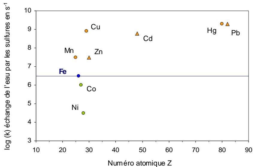
**Figure 4.18.** Cinétiques d'échange de l'eau par les sulfures en fonction du numéro atomique. Les éléments symbolisés par un triangle (Zn, Cd et Pb) ne sont pas pyritisés de manière significative [d'après Morse et Luther (1999)].
