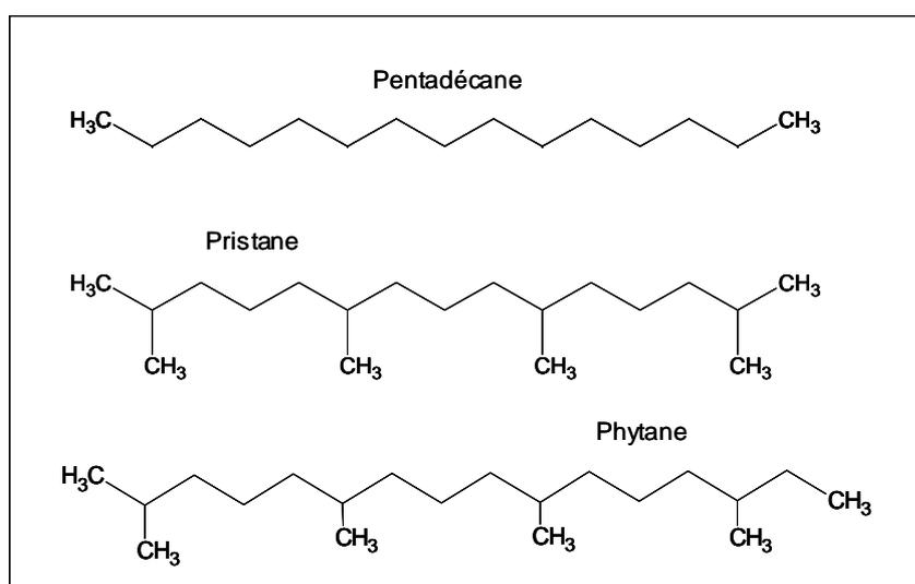
**Figure 1.6.** Structures du *n*-alcane pentadécane et des composés isoprénoïques pristane et phytane.
