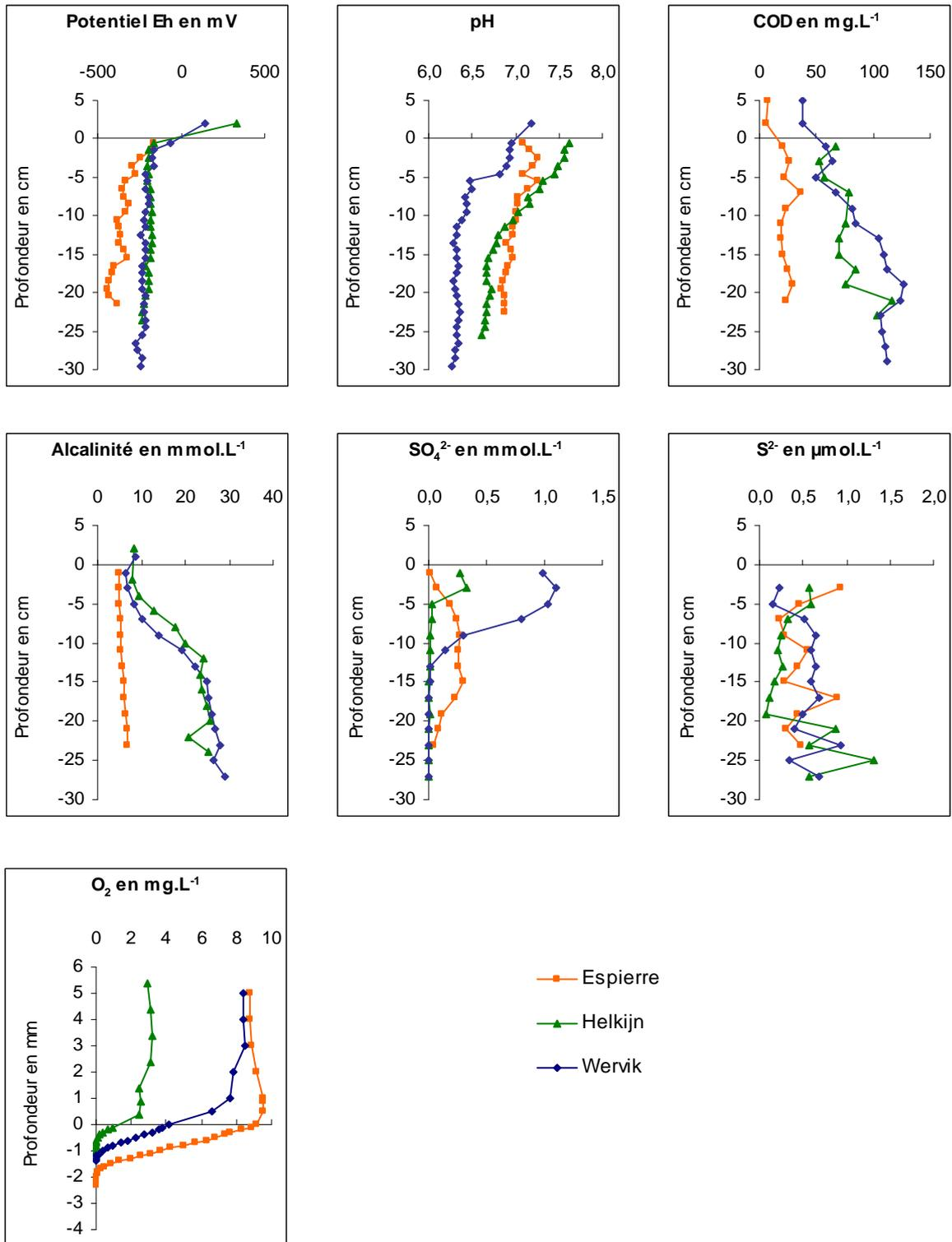
**Figure A1 :** Evolutions en fonction de la profondeur du potentiel Eh (en mV par rapport à Ag/AgCl), du pH, du carbone organique dissous (COD, en mg.L<sup>-1</sup>), de l'alcalinité (en mmol.L<sup>-1</sup>), des concentrations en sulfates (en mmol.L<sup>-1</sup>) et en sulfures (en μmol.L<sup>-1</sup>) et de l'oxygène dissous en (mg.L<sup>-1</sup>, échelle des ordonnées en mm) dans les eaux interstitielles des sites de l'Espierre, d'Helkijn et de Wervik.
