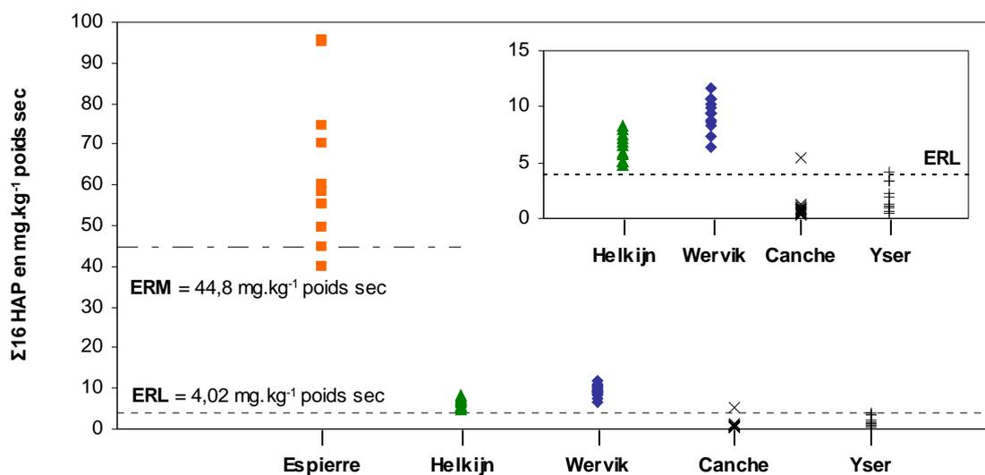
Figure 3.18. Evaluation de la qualité des sédiments des sites de l'Espierre, d'Helkijn, de Wervik (carottes sédimentaires) et des sédiments superficiels de la Canche et de l'Yser par rapport aux valeurs seuils ERL (effect range low) et ERM (effect range medium).
