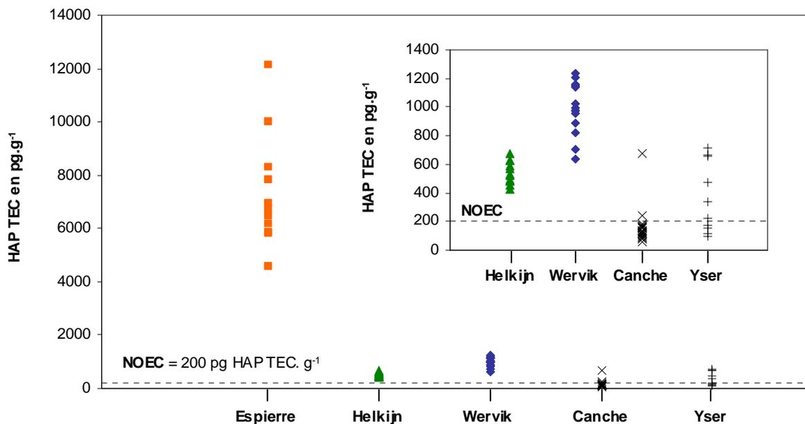
**Figure 3.22.** Quantités toxiques équivalentes à la dioxine, exprimées en  $\text{pg.g}^{-1}$ , dans les carottes sédimentaires de l'Espierre, d'Helkijn et de Wervik et dans les sédiments superficiels de l'Yser et de la Canche (NOEC : no observed effect concentration).
