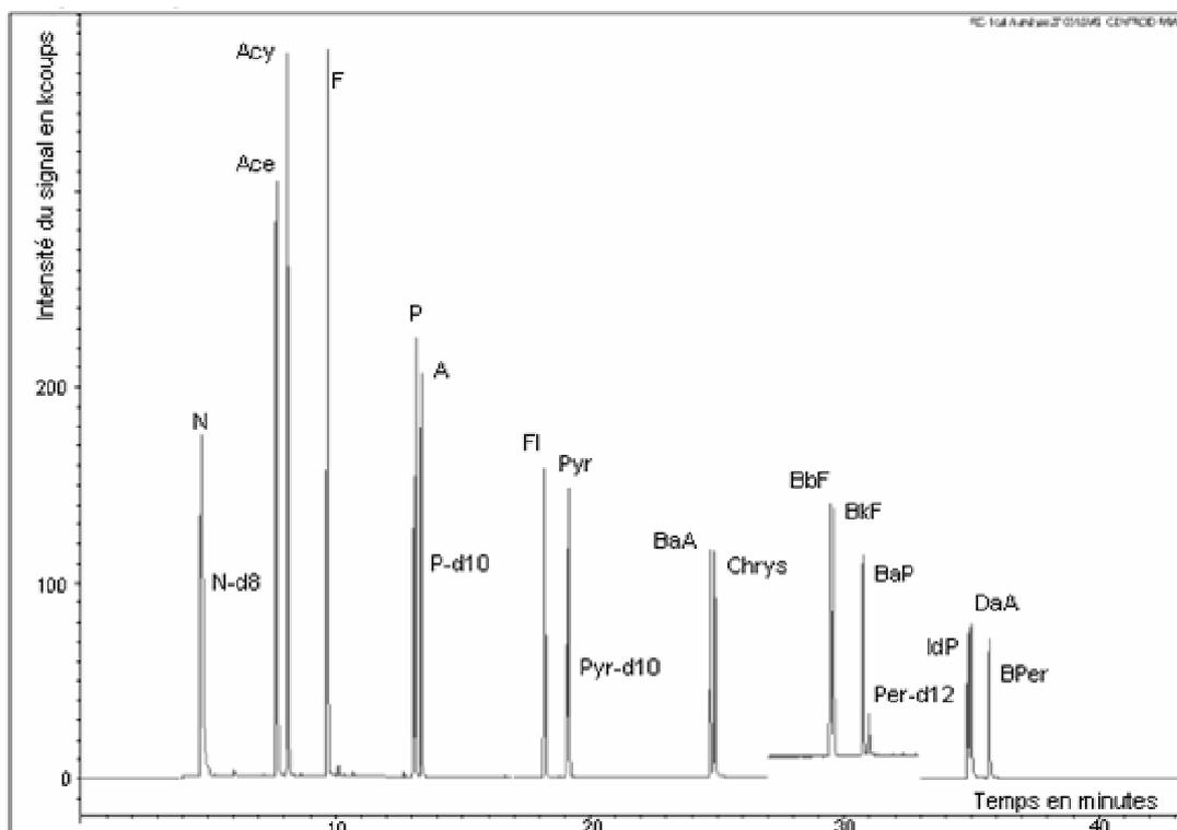
**Figure 2.17.** Chromatogramme obtenu après injection d'une solution de calibration contenant  $5\text{ng}\cdot\mu\text{L}^{-1}$  de chaque composé.
