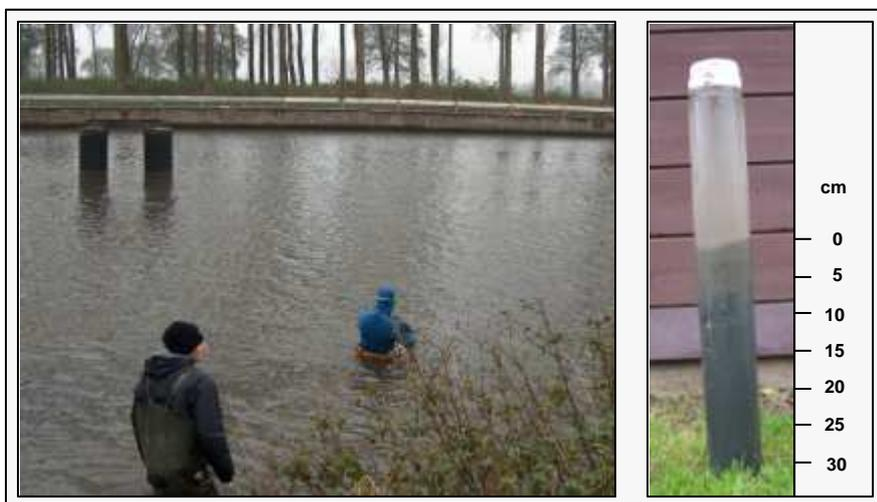
**Figure 2.6.** Prélèvement des carottes sédimentaires par plongée (ici, site d'Helkijn) et photographie du carottier après prélèvement du sédiment.
