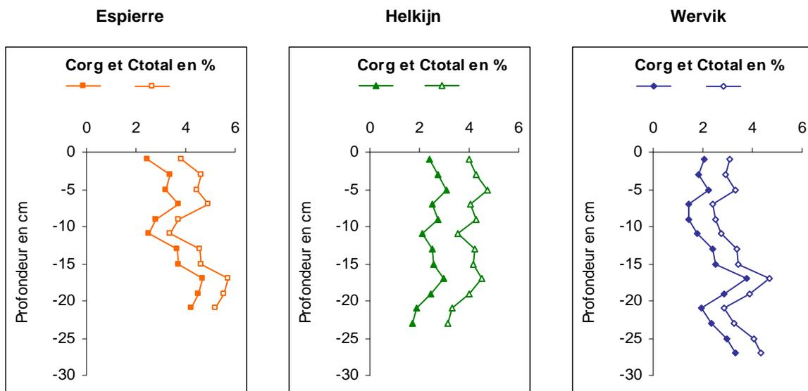
**Figure 3.5.** Teneurs en carbone total (Ctotal) et en carbone organique (Corg), exprimées en fractions massiques relatives (%) par rapport au poids sec de sédiment, pour les trois sites de l'Espierre, d'Helkijn et de Wervik.
