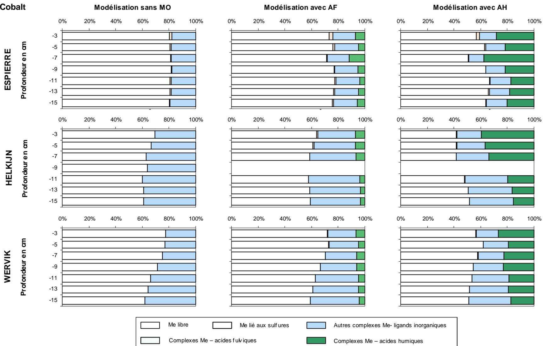
**Figure 4.6.** Répartitions (en %) des différentes espèces du cobalt en fonction de la profondeur pour les trois sites de l'Espièrre, d'Helkijn et de Wervik en considérant une modélisation sans matière organique (MO), avec acides fulviques (AF) et avec acides humiques (AH).
