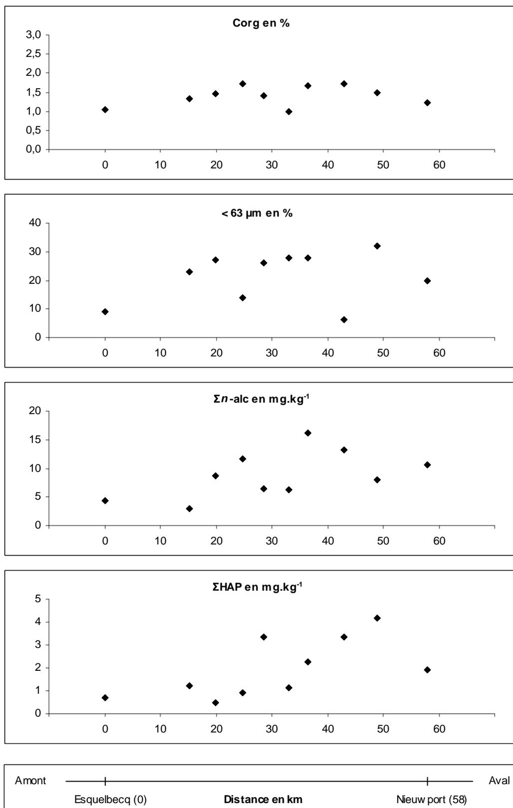
Figure 3.15. Distributions longitudinales (en fonction du point kilométrique) de la teneur en carbone organique sédimentaire (en %), de la fraction de particules fines < 63 µm (en %), de la concentration totale en n-alcanes (Σn-alc) (en mg.kg<sup>-1</sup>, poids sec) et de la concentration totale en HAP (en mg.kg<sup>-1</sup>, poids sec) pour les sédiments superficiels du canal de l'Yser.
