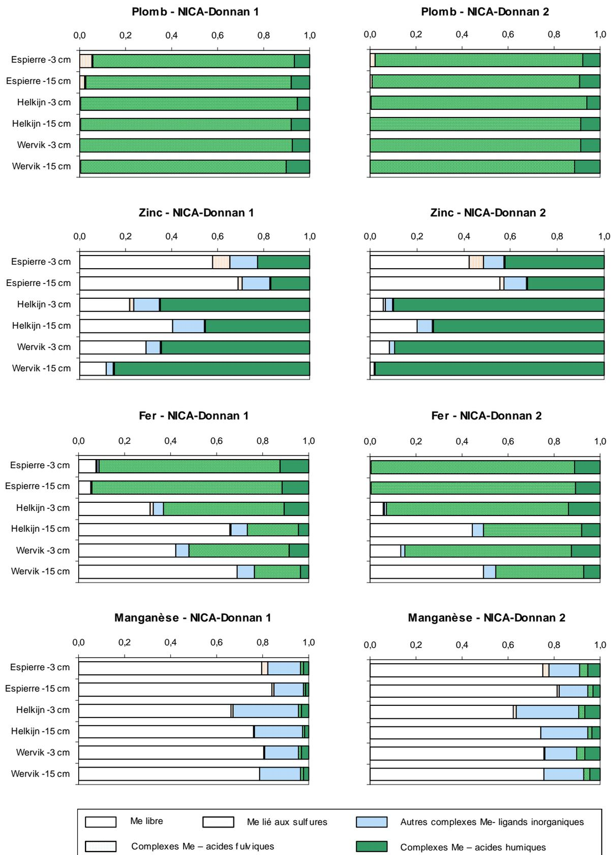
**Figure A3 :** Spéciations (en %) obtenues pour le plomb, le zinc, le fer et le manganèse dans les eaux interstitielles (-3 et -15 cm) des sites de l’Espierre, de Wervik et d’Helkijn en intégrant dans le modèle les données du carbone organique dissous (NICA-Donnan 1) ou en doublant cette quantité (NICA-Donnan 2).
