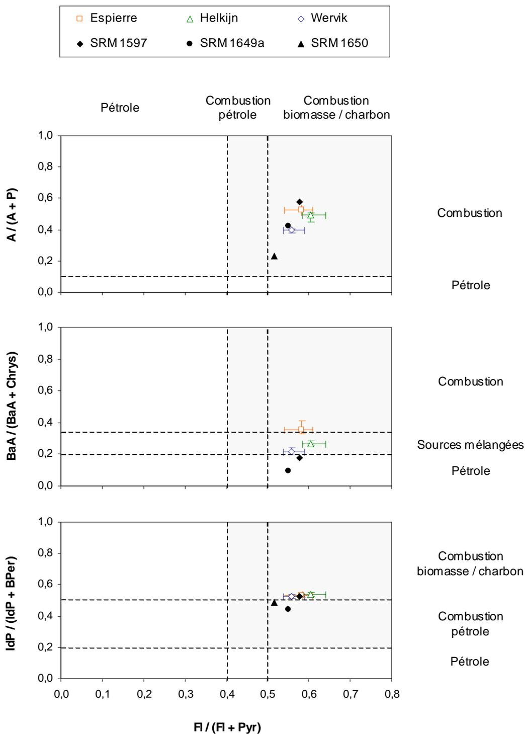
**Figure 3.13.** Caractérisation de l'origine de la contamination par les HAP : valeurs des rapports d'isomères pour les sédiments de l'Espierre, d'Helkijn et de Wervik ainsi que pour les matériaux de référence SRM 1597 (goudron de houille), 1649a (poussières urbaines) et 1650 (particules diesel) et délimitation des secteurs caractéristiques des processus pyrolytiques et pétrogéniques [d'après Oros et Ross (2004) et Yunker et al. (2002)].
