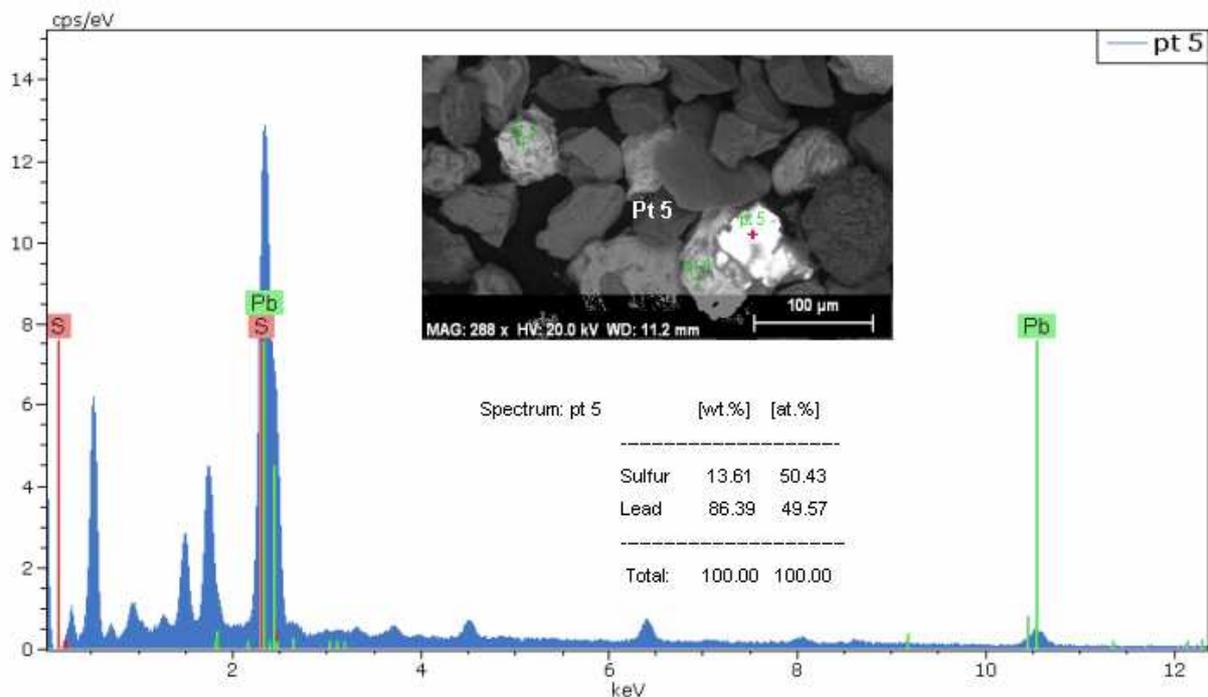
Figure 4.22. Vue par microscopie à balayage électronique et microanalyse en énergie dispersive pour le point 5 (cas du sédiment d'Helkijn, 15 cm de profondeur).
