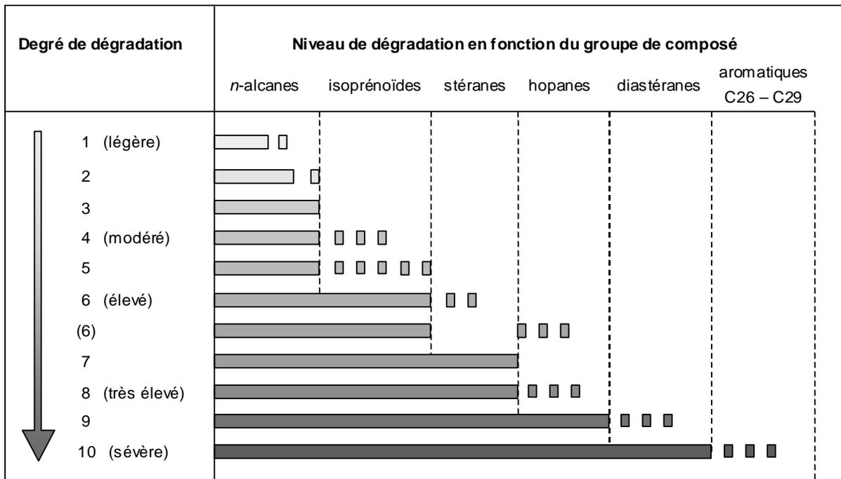
**Figure 3.10.** Schéma illustrant les différents niveaux de biodégradation pour un pétrole mature typique [d'après Peters et Moldowan (1993)].
