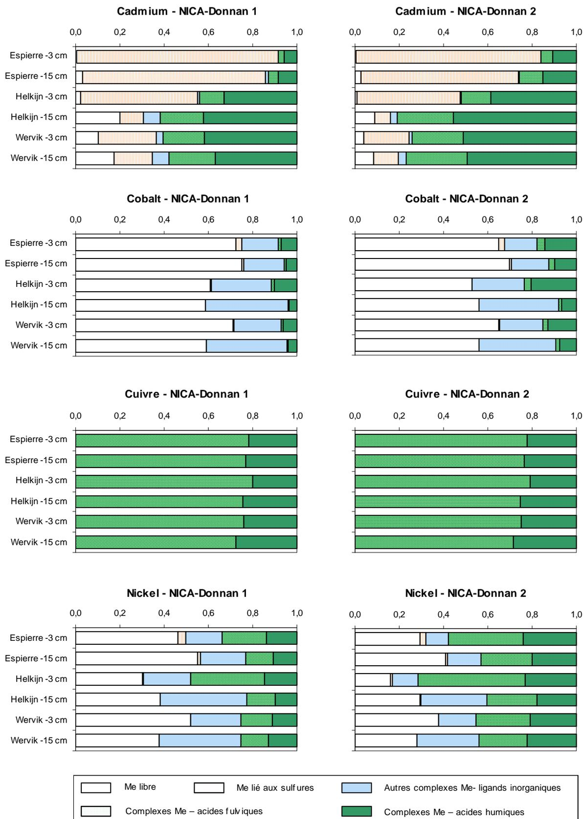
**Figure A2 :** Spéciations (en %) obtenues pour le cadmium, le cobalt, le cuivre et le nickel dans les eaux interstitielles (-3 et -15 cm) des sites de l'Espierre, de Wervik et d'Helkijn en intégrant dans le modèle les données du carbone organique dissous (NICA-Donnan 1) ou en doublant cette quantité (NICA-Donnan 2).
