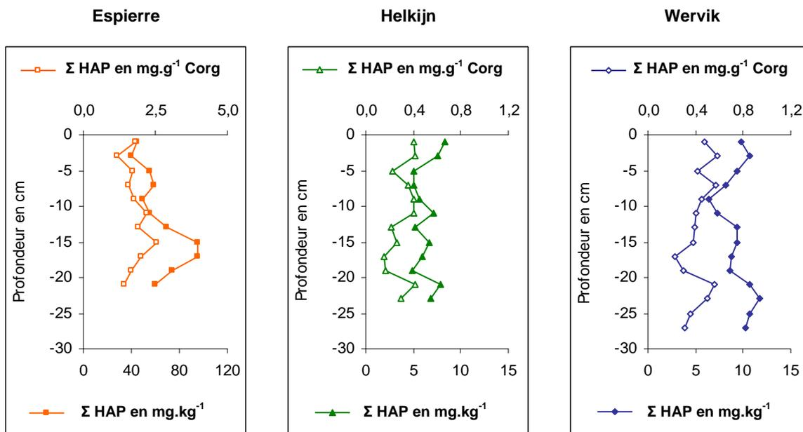
**Figure 3.2.** Somme des concentrations des 16 HAP étudiés, exprimées en mg.kg<sup>-1</sup> (poids sec, échelle inférieure) et en mg.g<sup>-1</sup> de carbone organique (Corg, échelle supérieure), en fonction de la profondeur pour les sites de l'Espierre, d'Helkijn et de Wervik.
