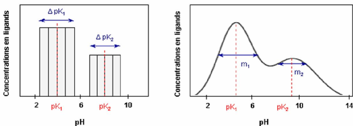
**Figure 4.2.** Exemples de distribution des sites de liaison de la MO : distribution discrète dans le cas du modèle SHM à gauche (van Schaik, 2008) et distribution bimodale et continue dans le cas du modèle NICA-Donnan à droite (USEPA, 1998).
