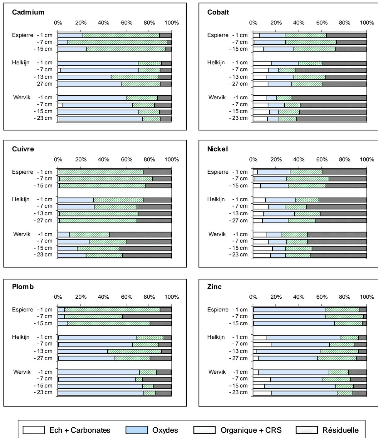
**Figure 4.15.** Répartitions (en %) du cadmium, du cobalt, du cuivre, du nickel, du plomb et du zinc dans les fractions sédimentaires échangeable + carbonate, oxydes, organique + CRS et résiduelle.
