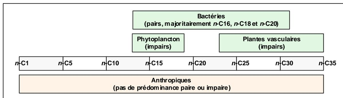
**Figure 1.7.** Schéma général de la distribution des *n*-alcanes en fonction de la source [d'après Rocher (2003) et Saliot (1994)].
