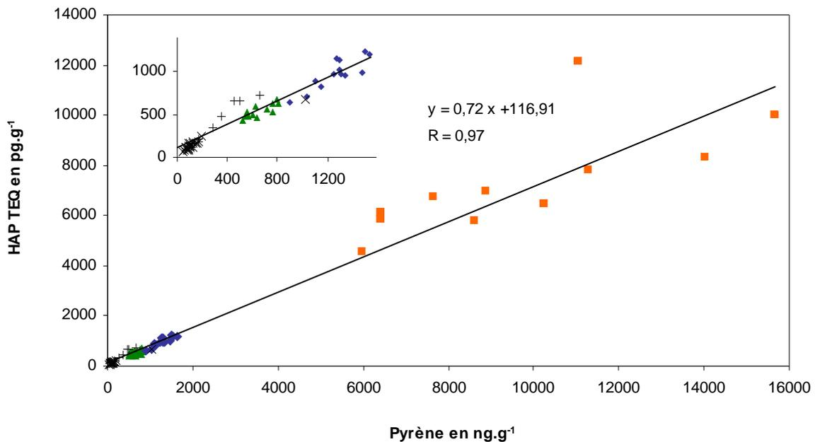
**Figure 3.23.** Relation entre les quantités toxiques équivalentes (en pg HAP TEQ.g<sup>-1</sup>) et les concentrations en pyrène (en ng.g<sup>-1</sup> poids sec) pour les sédiments de l'Espierre (■), d'Helkijn (▲), de Wervik (◆), de la Canche (x) et de l'Yser (+).
