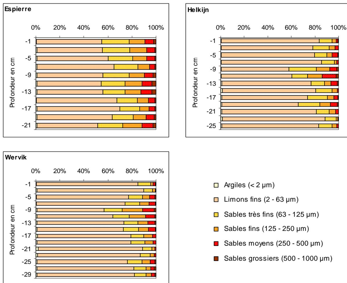
**Figure 3.6.** Distribution granulométrique (en % de chaque fraction) observée en fonction de la profondeur pour les trois sites de l’Espierre, d’Helkijn et de Wervik.
