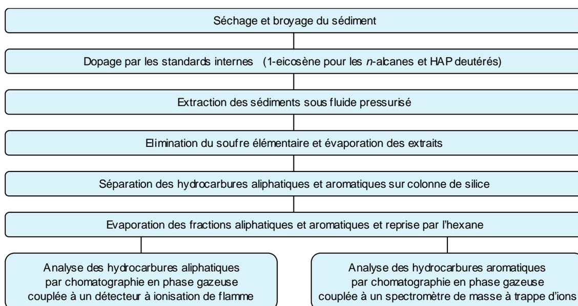
**Figure 2.9.** Schéma général de la méthodologie employée pour l'analyse des hydrocarbures aliphatiques et aromatiques.
