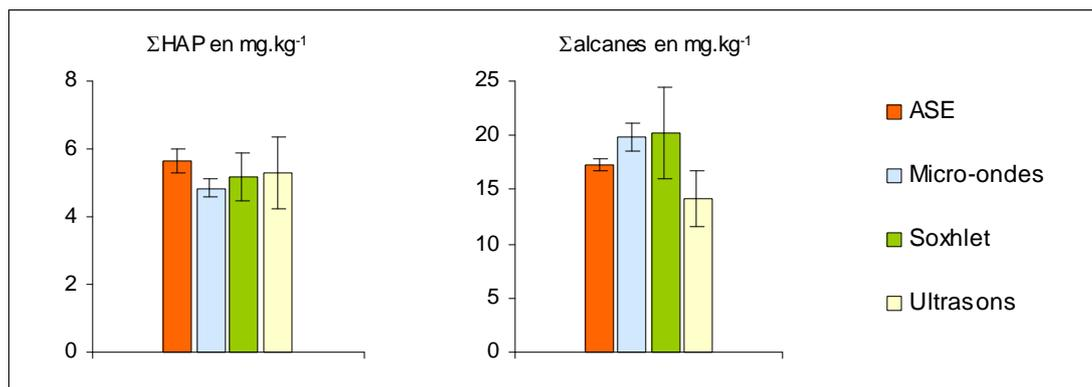
Figure 2.12. Concentrations totales de HAP et de *n*-alcanes extraites exprimées en mg.kg<sup>-1</sup> poids sec en fonction de la méthode d'extraction (n = 3).
