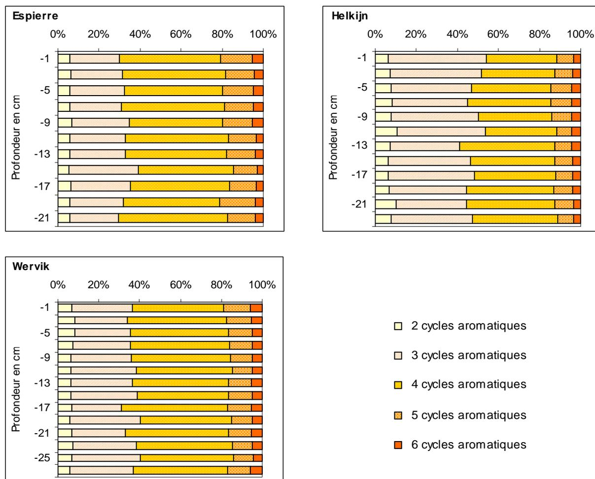
Figure 3.12. Répartition des HAP entre les différentes classes d'aromaticité en % en fonction de la profondeur pour les sites de l'Espierre, d'Helkijn et de Wervik.
