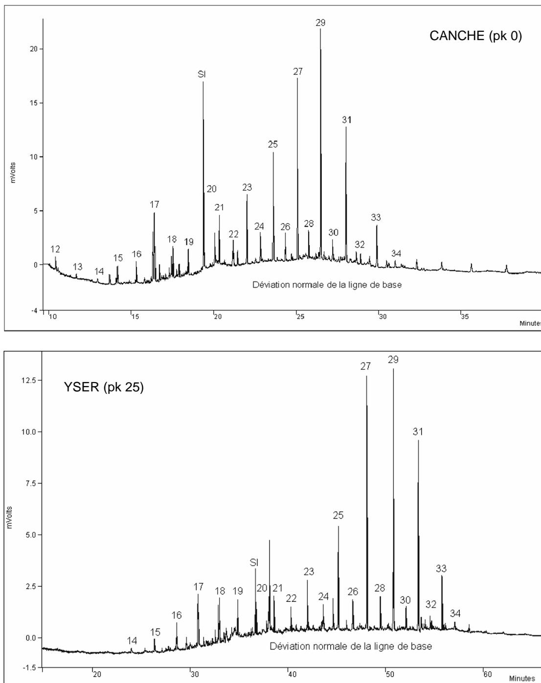
Figure 3.16. Chromatogrammes des fractions aliphatiques obtenus dans le cas des sédiments de l'Yser et de la Canche (SI : standard interne, pk : point kilométrique).
