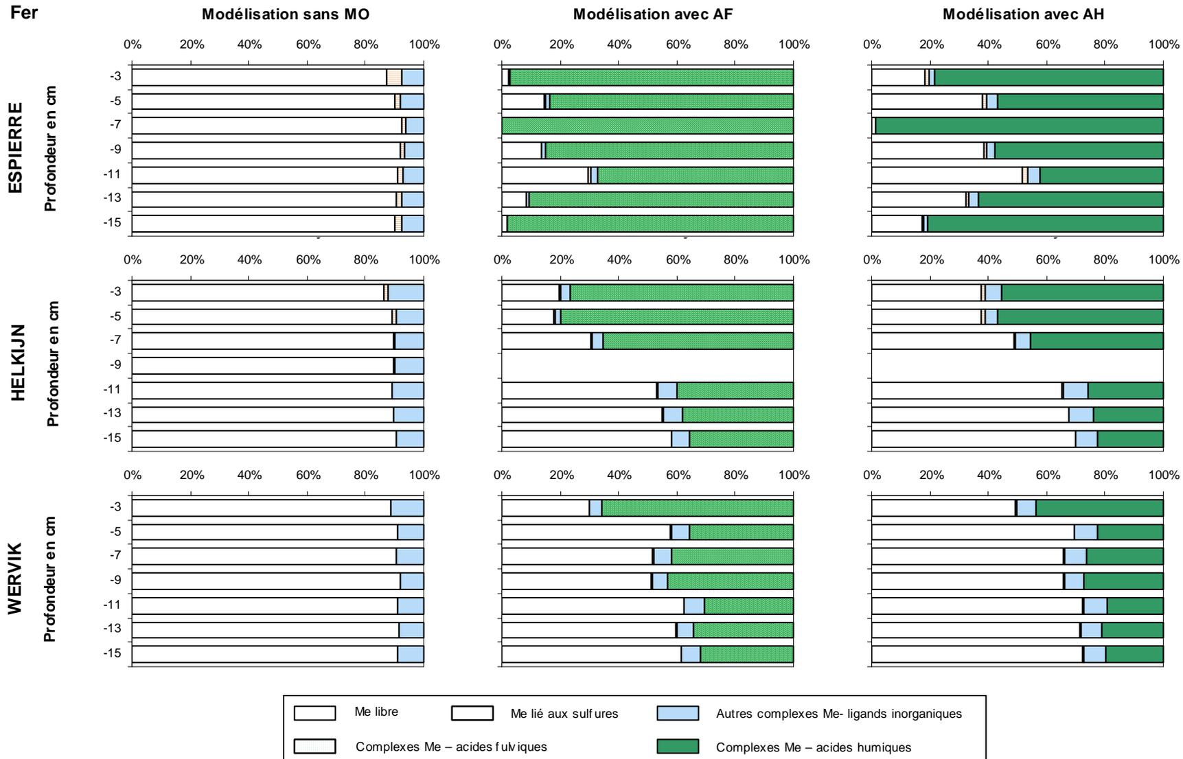
**Figure 4.3.** Répartitions (en %) des différentes espèces du fer en fonction de la profondeur pour les trois sites de l’Espierre, d’Helkijn et de Wervik en considérant une modélisation sans matière organique (MO), avec acides fulviques (AF) et avec acides humiques (AH).
