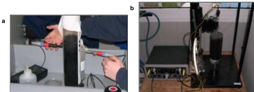
**Figure 2.8.** Mesures du potentiel, du pH (a) et de l'oxygène dissous (b).
