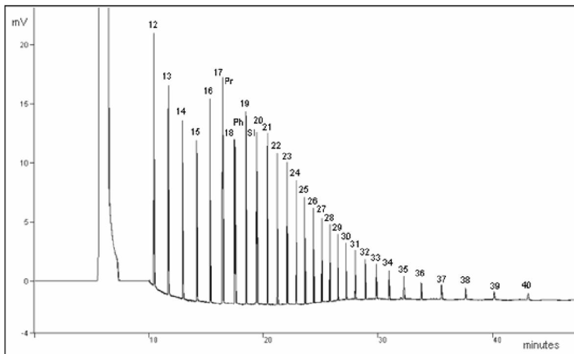
**Figure 2.15.** Exemple de chromatogramme obtenu dans le cas de la solution de calibration contenant  $10 \text{ ng} \cdot \mu\text{L}^{-1}$  de chaque composé [*n*-alcanes du *n*-C12 au *n*-C40, pristane (Pr), phytane (Ph) et 1-éicosène (SI)].
