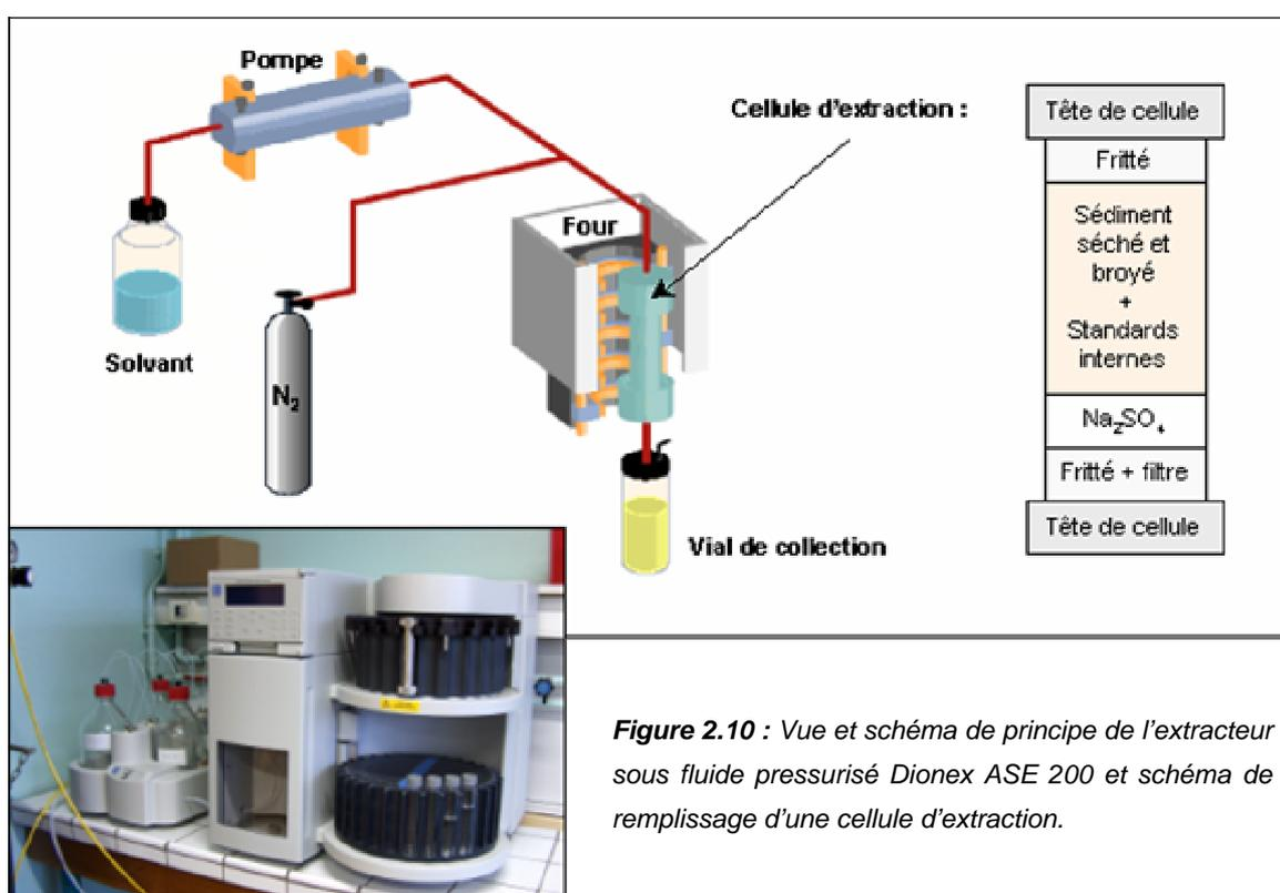
**Figure 2.10 :** Vue et schéma de principe de l'extracteur sous fluide pressurisé Dionex ASE 200 et schéma de remplissage d'une cellule d'extraction.
