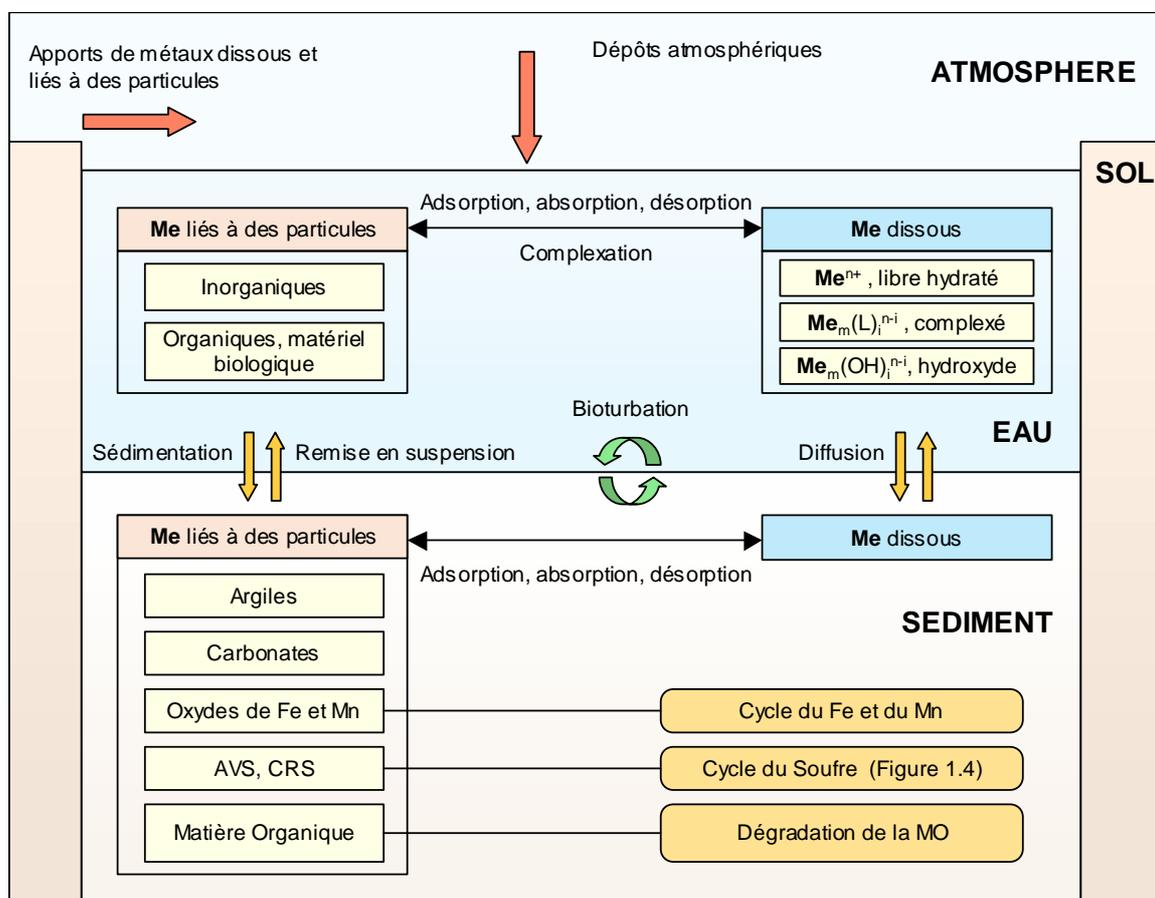
**Figure 1.3.** Mécanismes principaux affectant le devenir des éléments traces métalliques (Me) dans le milieu aquatique (L : ligand) [d'après Garnier (2004) et Sigg (1992)].
