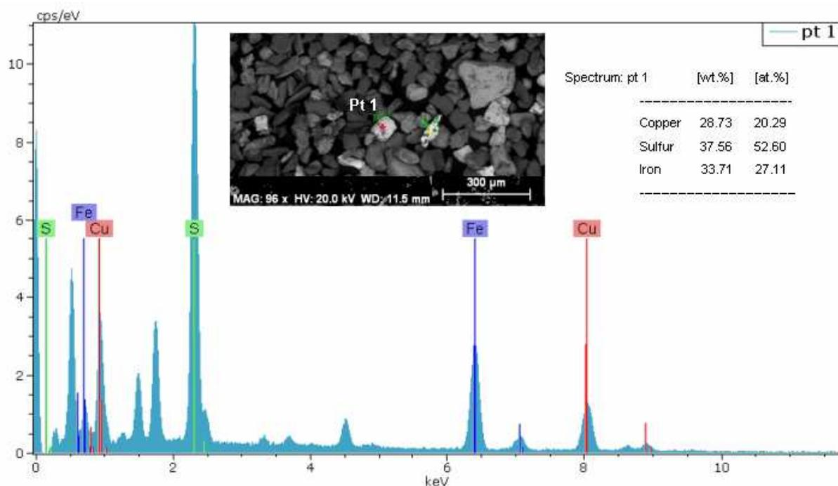
**Figure 4.23.** Vue par microscopie à balayage électronique et microanalyse en énergie dispersive pour le point 1 (cas du sédiment d'Helkijn, 15 cm de profondeur).
