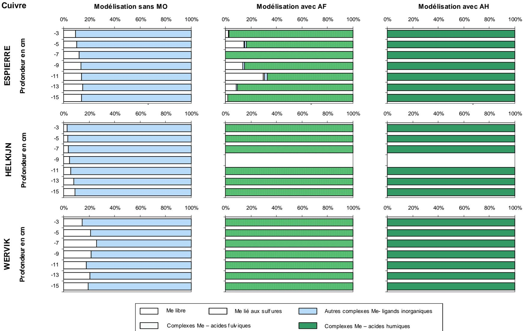
**Figure 4.7.** Répartitions (en %) des différentes espèces du cuivre en fonction de la profondeur pour les trois sites de l’Espierre, d’Helkijn et de Wervik en considérant une modélisation sans matière organique (MO), avec acides fulviques (AF) et avec acides humiques (AH).
