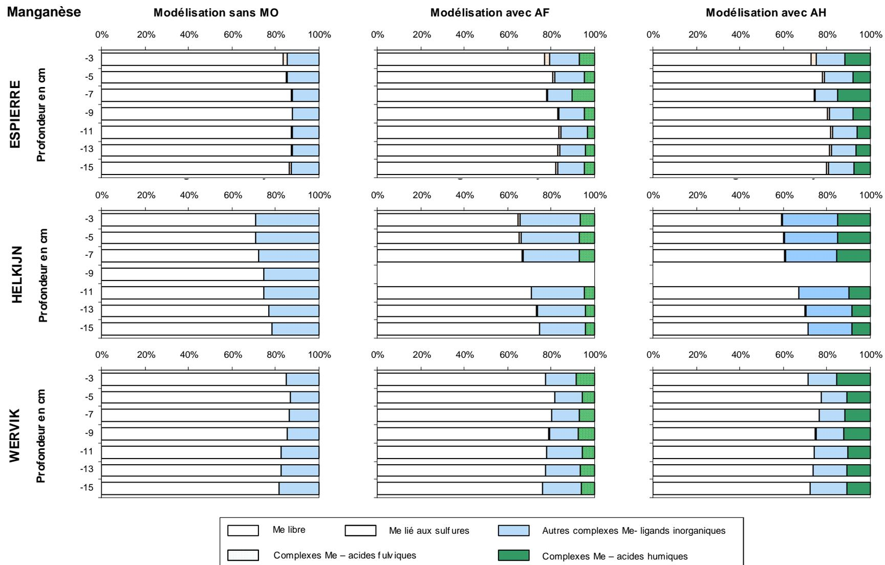
**Figure 4.4.** Répartitions (en %) des différentes espèces du manganèse en fonction de la profondeur pour les trois sites de l'Espierre, d'Helkijn et de Wervik en considérant une modélisation sans matière organique (MO), avec acides fulviques (AF) et avec acides humiques (AH).
