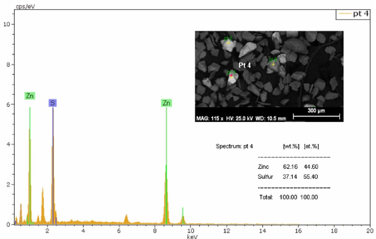
**Figure 4.21.** Vue par microscopie à balayage électronique et microanalyse en énergie dispersive pour le point 4 (cas du sédiment de l'Espierre, 15 cm de profondeur).
