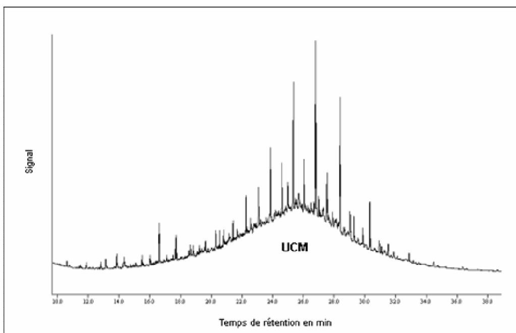
**Figure 1.8.** Déviation caractéristique de la ligne de base correspondant à l'UCM (Unresolved Complex Mixture) (exemple de la fraction aliphatique extraite du sédiment superficiel du site de Wervik).
