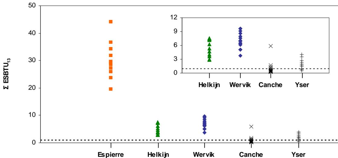
Figure 3.20. Evaluation de la qualité des sédiments suivant la procédure établie par l'USEPA (ESB, equilibrium partitioning sediment benchmarks) : indice de toxicité  $\Sigma$  ESBTU<sub>13</sub> et valeur seuil égale à 1.
