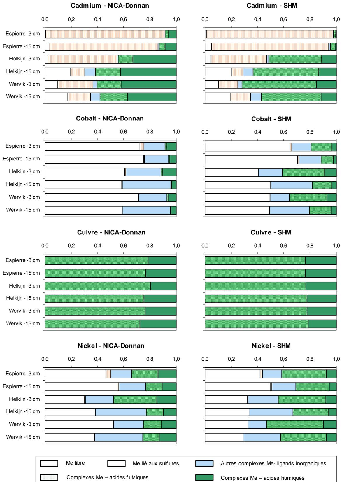
Figure 4.11. Comparaisons des modèles NICA-Donnan et SHM : répartitions (en %) du cadmium, du cobalt, du cuivre et du nickel entre les formes libre, liée aux sulfures, complexée avec d'autres ligands inorganiques (carbonates, phosphates, sulfates, chlorures) et complexée avec les acides fulviques et humiques, dans les eaux interstitielles (-3 et -15 cm) des sites de l'Espierre, de Wervik et d'Helkijn.
