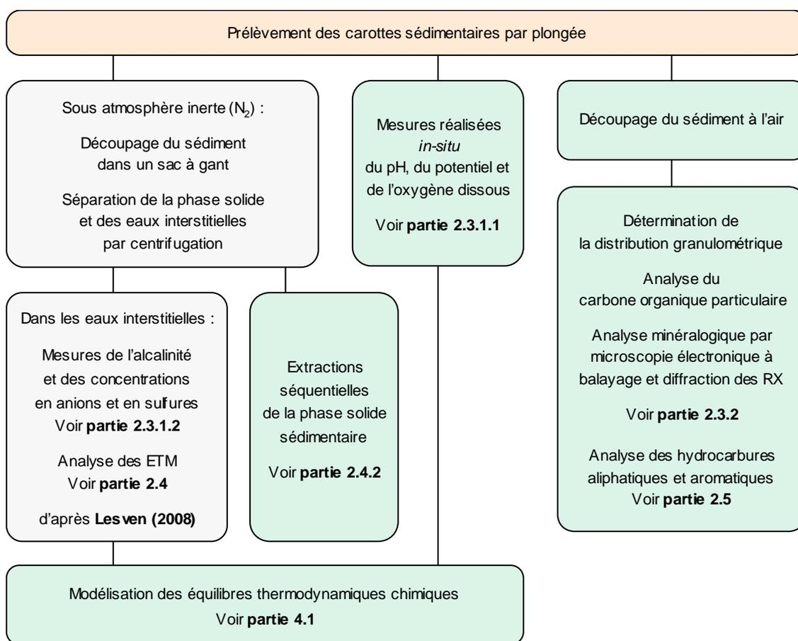
Figure 2.7. Schéma général des analyses et mesures réalisées sur les carottes sédimentaires.
