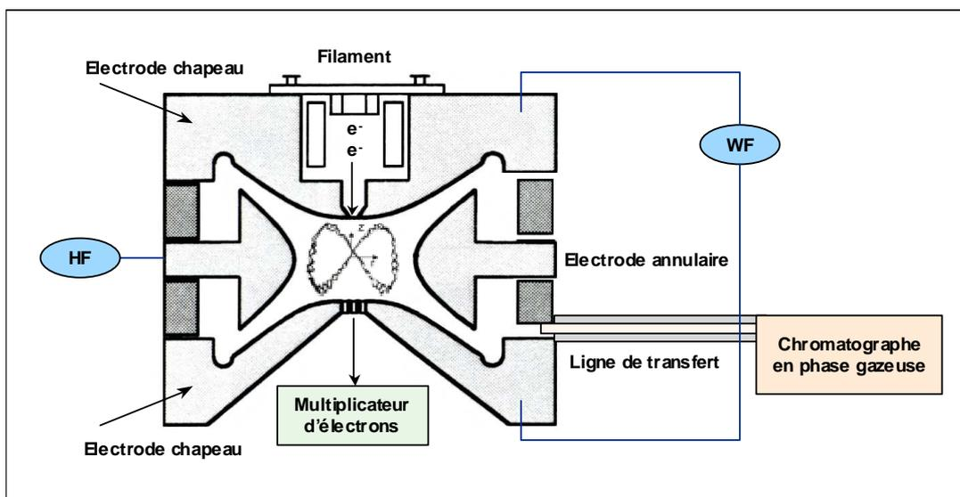
**Figure 2.16.** Vue en coupe de la trappe d'ions et de la trajectoire stable des ions à l'intérieur de la trappe.
