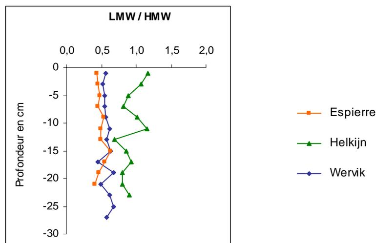
**Figure 3.11.** Evolutions en fonction de la profondeur de l'indice LMW / HMW (rapport des HAP de faible poids moléculaire sur les HAP de haut poids moléculaire) pour les sites de l'Espierre, d'Helkijn et de Wervik.
