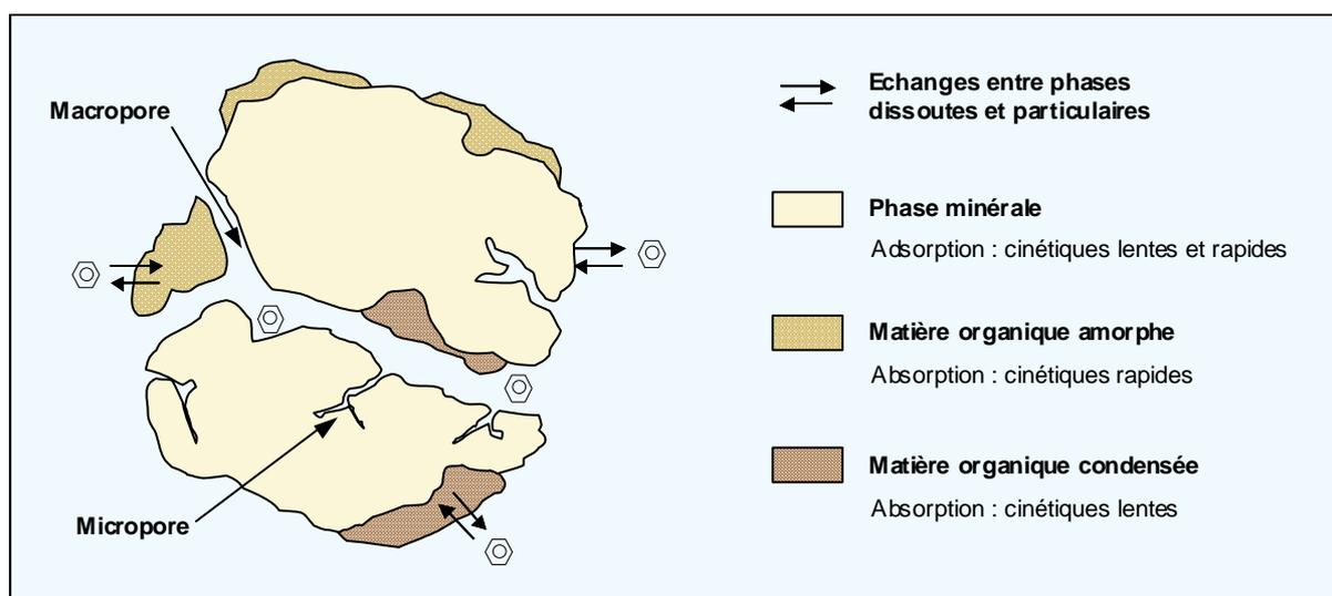
**Figure 1.10.** Mécanismes de sorption intervenant à l'interface eau – matière particulaire [d'après Tronczynski *et al.* (2006) et Pignatello et Xing. (1996)].
