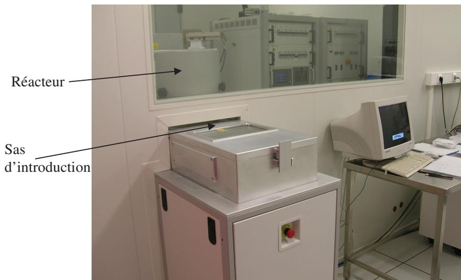
**Figure II.18** : Photographie du bâti de gravure profonde (Surface Technology System STS, UK) utilisé pour la fabrication de sources d'électronébulisation.
