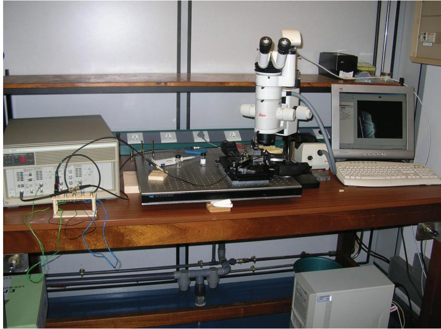
**Figure III.48 :** Photographie du banc de caractérisation utilisé pour les tests d'électronébulisation.
