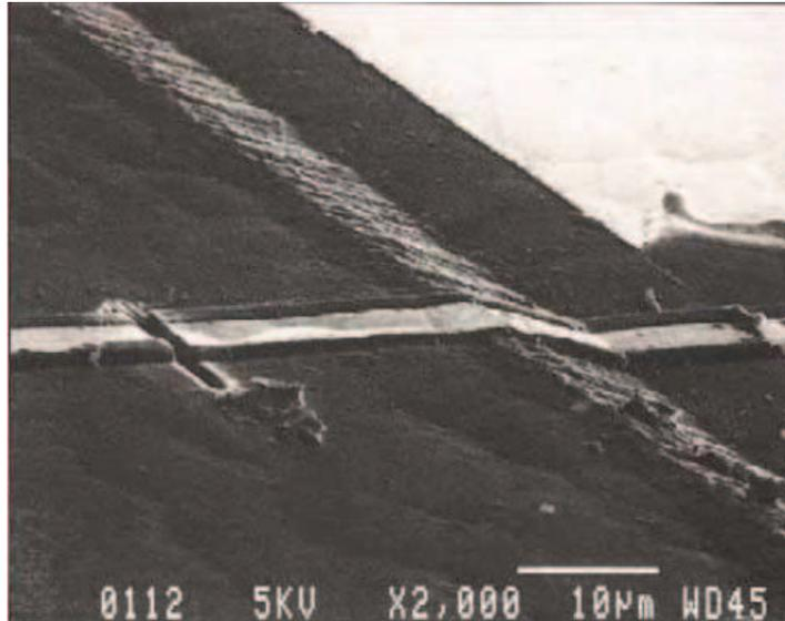
**Figure 2 :** *Usinage de miroirs après la fabrication d'un laser à semi-conducteur. La méthode permet la fabrication de structures gravées 3D, aux propriétés optiques satisfaisantes, sans dommages notables pour la région active [Sud 88].*
