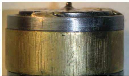
Rys. 5.3. Zarysowanie powierzchni pierścienia prowadzącego wewnątrz obudowy amortyzatora
