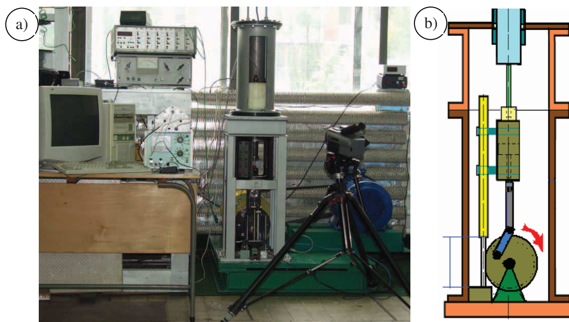
Rys. 3.4. Stanowisko do badań amortyzatorów i tłumików z kinematycznym wymuszeniem ruchu; a) widok stanowiska, b) schemat działania
