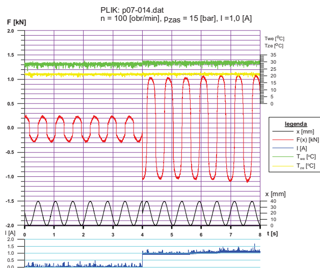
Rys. 20. Wykres siły F [kN] w czasie, dla prędkości kinematycznego wymuszenia ruchu n = 100 [obr/min] i wartości natężenia prądu elektrycznego I = 1,0 [A]
