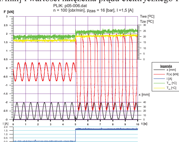
Rys. 9. Wykres siły F [kN] w czasie, dla prędkości kinematycznego wymuszenia ruchu n = 100 [obr/min] i wartości natężenia prądu elektrycznego I = 1,5 [A]
