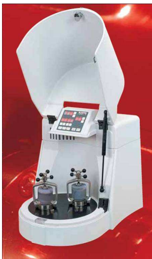
Figure I-7 : Broyeur planétaire, « La Pulvérisette 7 »
