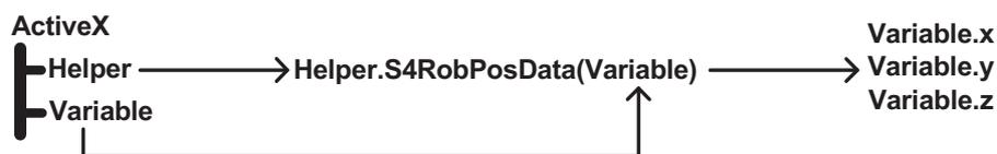
FIG. 4.6 – Récupération des Coordonnées du Robot
