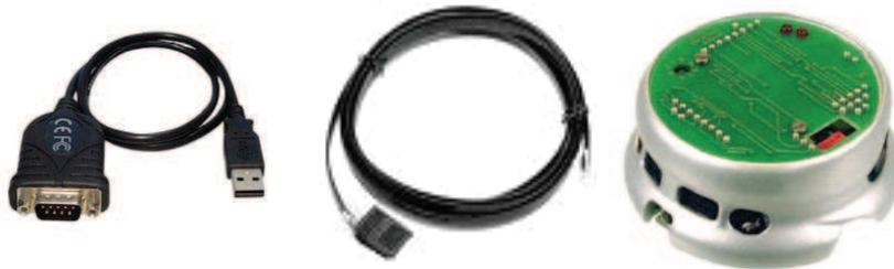
FIG. 3.4 – Robot Khepera et câble série RS232
