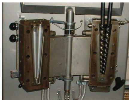
**Figure 35: Chambre d'extrusion de la micro-extrudeuse DSM**
