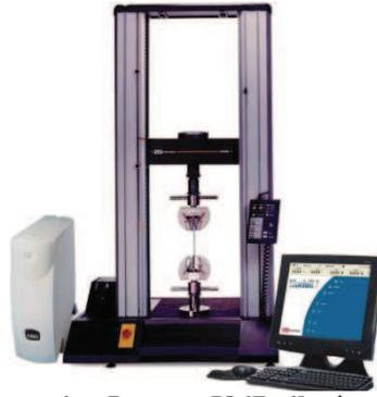
Figure 28: Banc de traction Instron 5867 piloté par le logiciel BlueHill
