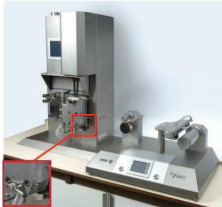
**Figure 34: Mini-fileuse DSM "Xplore Fiber Spin Line" équipée en série d'une micro-extrudeuse DSM Explore « Twin Screw Compounder »**
