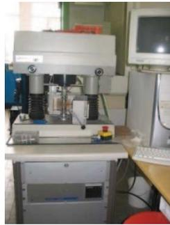
**Figure 27: Visco-analyseur VA 4000 de METRAVIB**
