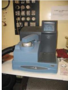
Figure 24 : DSC Q100 de TA Instruments
