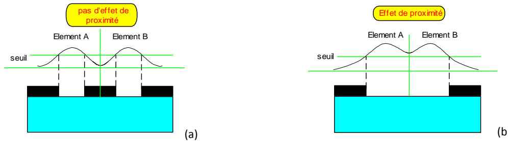
Figure 11.31 : Exemple d'illustration des effets de proximité sur l'exposition entre deux lignes proches ; (a) sans interaction, (b) avec effet de proximité.
