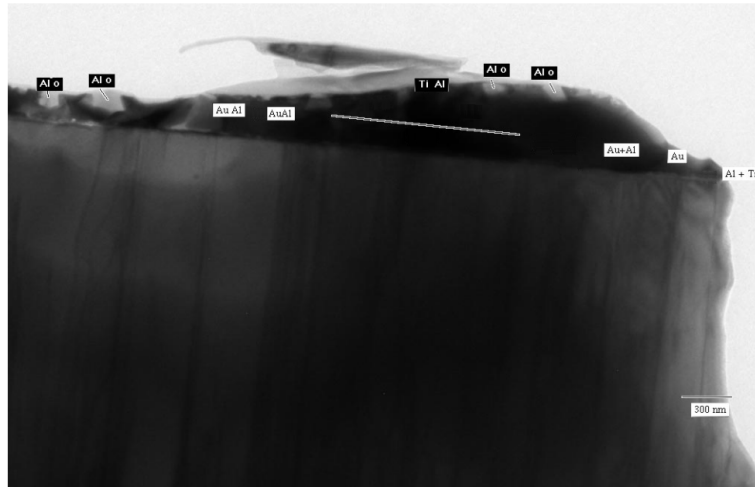
Figure III.15 : Image TEM d'un contact Ti/Al/Ni/Au sur AlGaN/GaN/Si de la couche A242.
