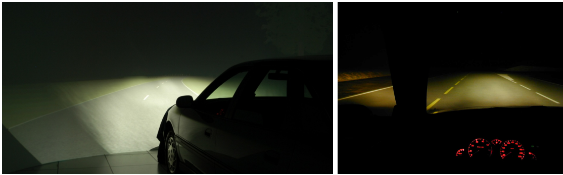
FIGURE 4.1 – Le simulateur d'éclairage du Centre Technique de Simulation, vu de l'extérieur (à gauche), et avec un point de vue depuis le poste de conduite (à droite).
