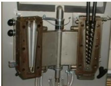
Figure 48 : Photographie de la chambre d'extrusion de la micro-extrudeuse DSM 15 cm<sup>3</sup>
