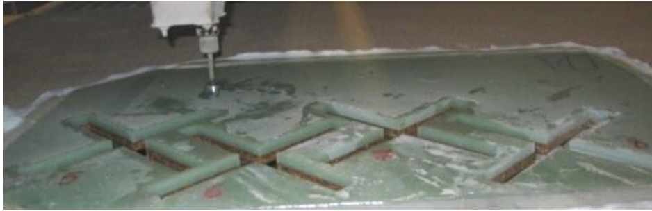
Figure III-118 : Fabrication d'éprouvettes par découpe jet d'eau
