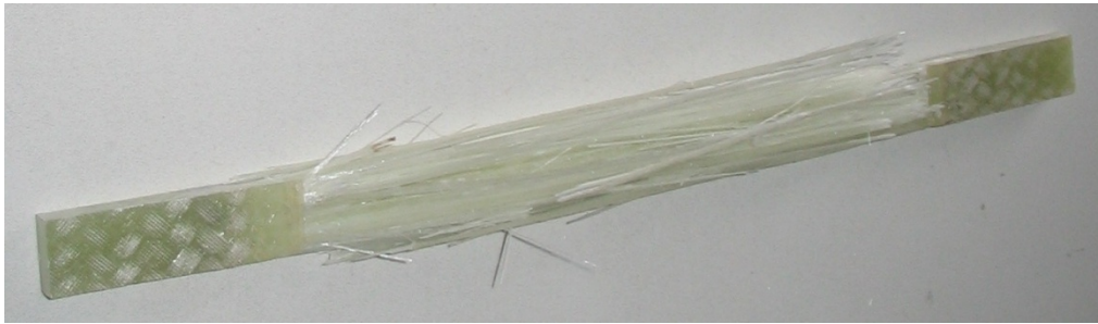
Figure I-35 : Type d'endommagement constaté sur un composite unidirectionnel
