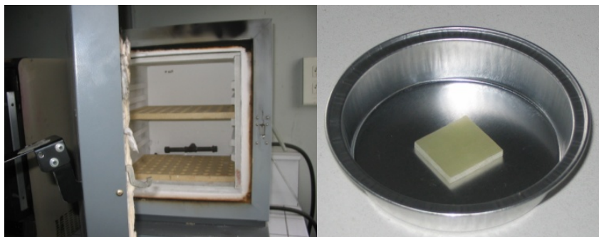
Figure I-24 : Four de cuisson et éprouvette de calcination
