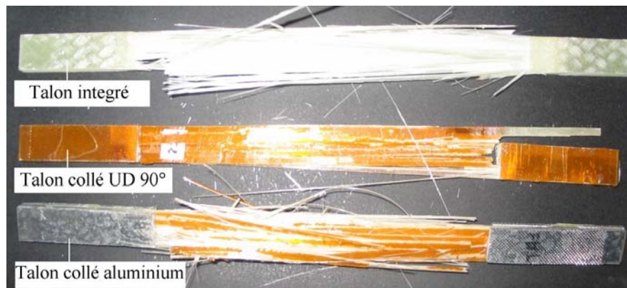
Figure I-27 : Comparaison d'endommagement sur 3 types de talons
