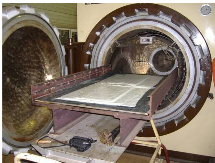
Figure II-44 : Fabrication de composite par autoclave
