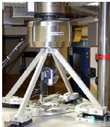
Figure III-107: Système de transformation de mouvement utilisé par Geiger [GEI05]
