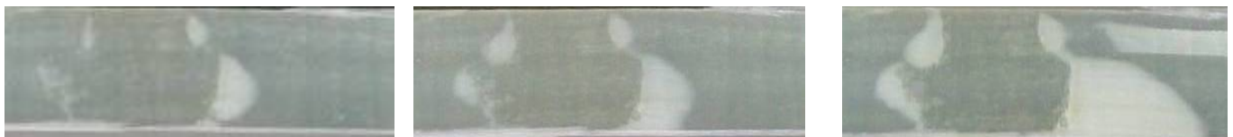
5000 cycles-25% perte de raideur 10500 cycles-33% perte de raideur 13000 cycles-41% perte de raideur
