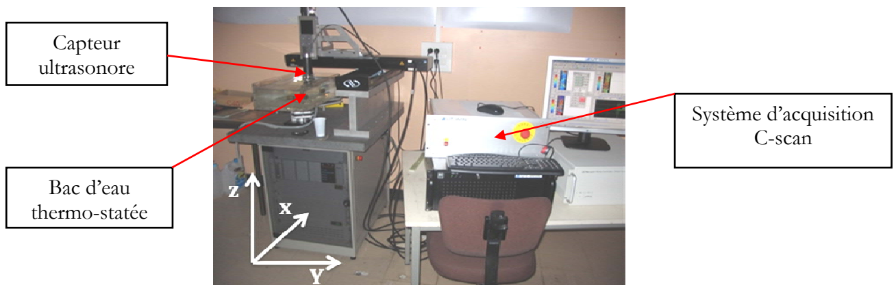
Figure II-63 : Matériel de détection par C-scan
