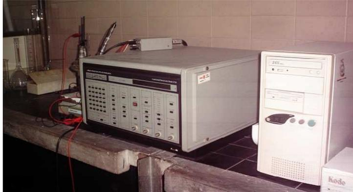
Figura 3.12.- Vista general del potenciostato, conectado con la celda electroquímica.
