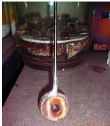
Figura 3.13.- Porta-cupón para colocar los recubrimientos a ser evaluados.
