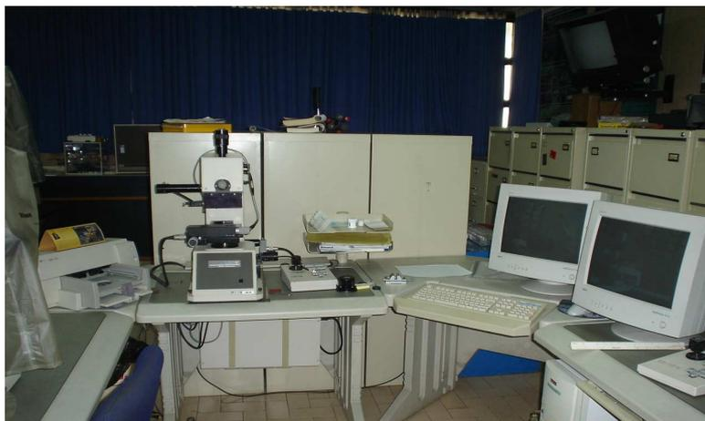
Figura 3.9.- Sistema de analizador de imágenes marca LECO modelo IA-3001.
