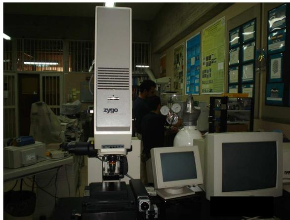
Figura 3.10.- Perfilómetro de interferometría óptica marca Zygo, modelo NewView 200.
