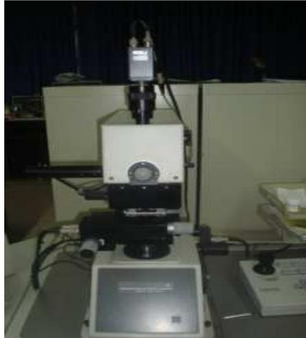
Figura 3.5.- Equipo de Microindentación Estática LECO M400-TT.
