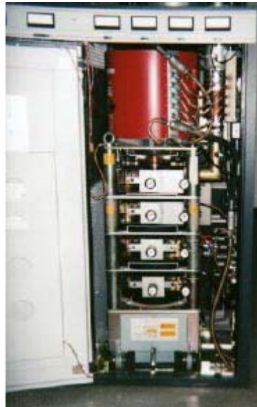
Figure 19 Exemple de réalisation de klystron.
