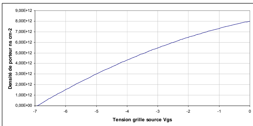
Figure 7 Simulations de la densité de porteur dans l'hétérojonction présentée en fonction de la tension V_{gs} . La courbe peut être approchée par un polynôme d'ordre 2.
