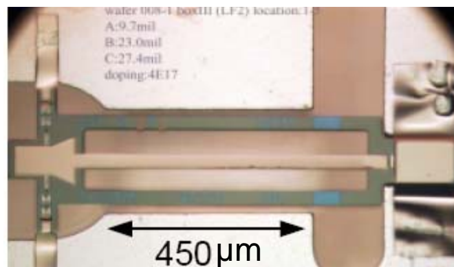
Figure 2 Réalisation d'un doubleur à 400GHz grâce à la technologie MEMS. La diode Schottky est placée à l'entrée du guide.
