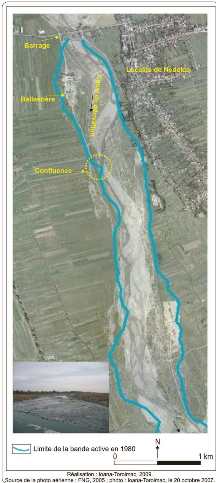
**Figure 69. Rétrécissement de la bande active en aval du barrage de Nedelea. La photo montre une image de la Prahova à la sortie du barrage. La bande active de tressage en 1980 est tracée à partir des cartes topographiques de la DTM.**
