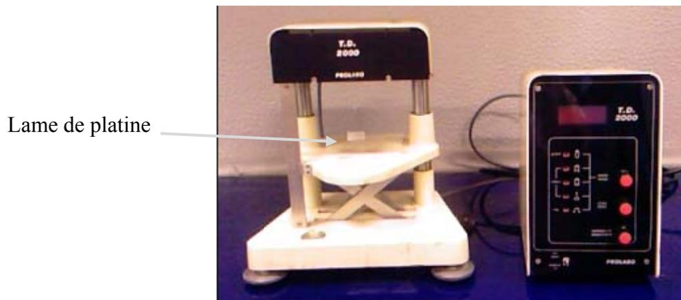
Figure 3- 6 : Tensiomètre
