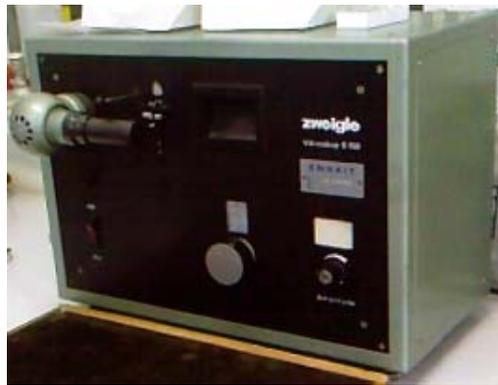
Figure 3- 1: Appareil Vibroskop (Zweigle)
