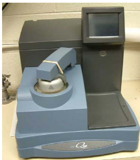
Figure 2.2.1. Appareil Q100 de TA-Instruments pour les essais de DSC.
