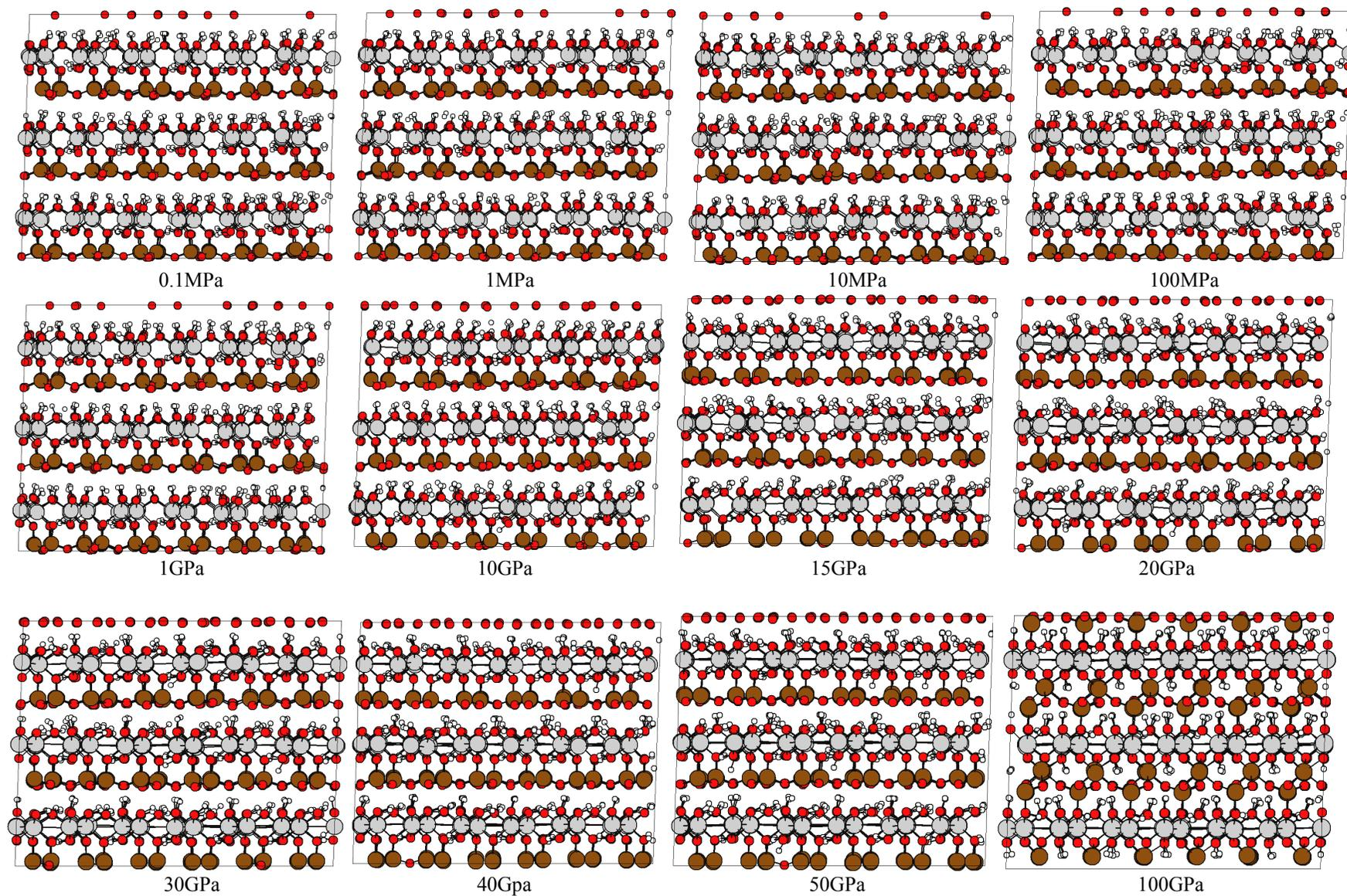
Figure IV.15. Comportement de la structure de la kaolinite sous pression, à  $T = 298$  K.
