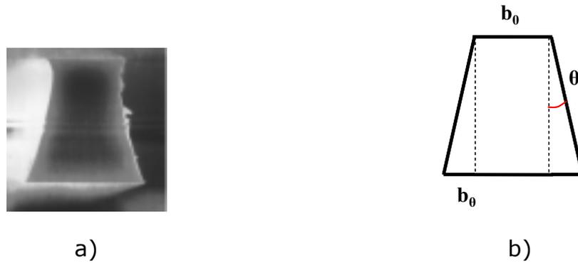
**Figure 67.** Déviation de la section rectangulaire d’une micro-poutre.
