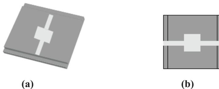
FIG. 2.3 – Cellule EHC ((a) en perspective et (b) de face). La zone claire représente la partie utile de la cellule (ITO).
