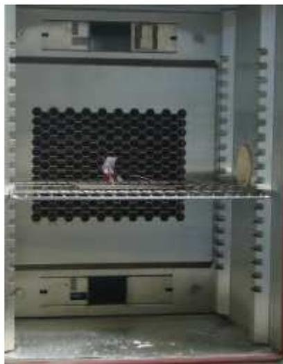
**Figure D-7 :** Echantillon textile placé au centre de l'enceinte climatique et relié au multimètre par des pinces crocodiles
