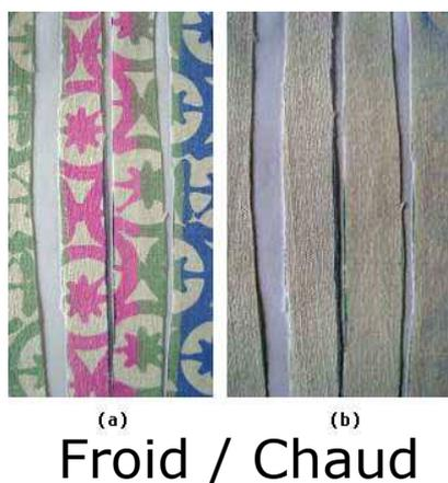
**Figure A-18 :** Exemple de textile réagissant à la chaleur grâce aux thermochromes [103]
