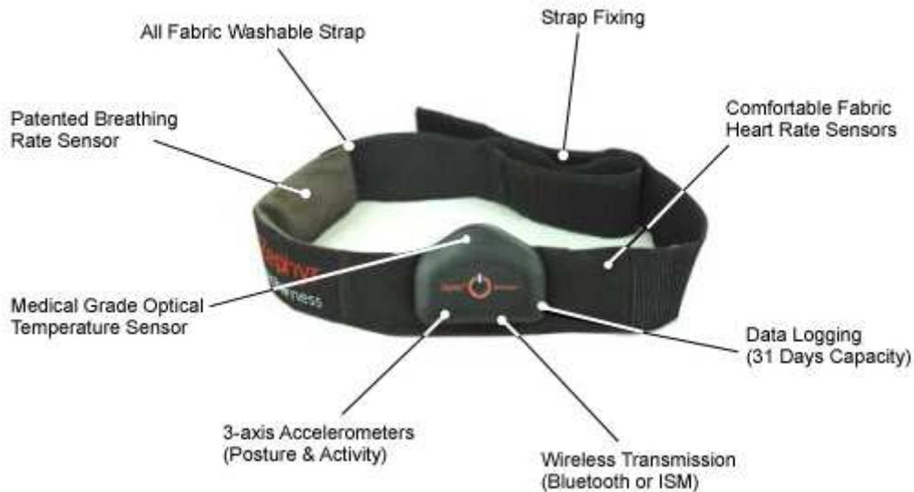
**Figure A-20** : Ceinture Zephyr permettant de collecter de multiples informations sur l'organisme [105]
