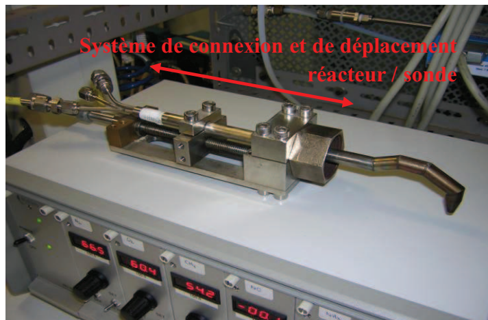
Figure 3.7 : Photographie de la sonde de prélèvement et de son système de connexion.
