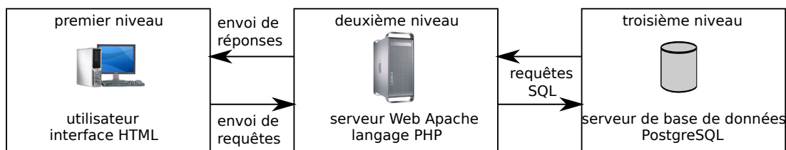
FIG. 3.2 – Architecture trois tiers de PLAMIDB. Les requêtes de l'utilisateur sont envoyées au serveur Web qui interroge la base de données et les résultats obtenus sont affichés à l'utilisateur.
