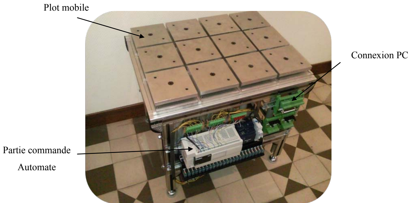
Fig. 53 Prototype du Support médicale avancée anti escarre (12plots mobiles)
