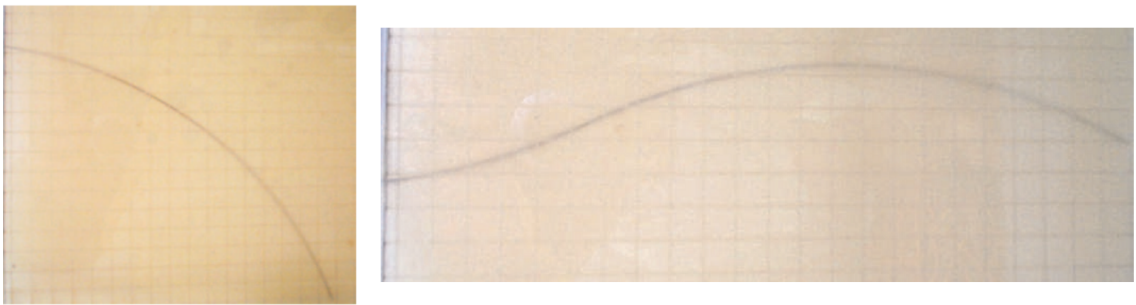
FIGURE 4.22 – Déflexions observées lors de l'insertion d'une aiguille biseautée flexible dans un matériau rigide. (à gauche) Une insertion simple durant laquelle l'aiguille est insérée sans la tourner de 23.5cm dans le fantôme. (à droite) Insertion avec rotation : l'aiguille est insérée tout d'abord de 8.3cm, puis elle est tournée de 180°, et enfin insérée de 16.7cm supplémentaires. [WKC + 06]
