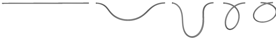
FIGURE 5.15 – Mise en évidence du couplage flexion-torsion. L'extrémité de droite est fixe, et l'on applique une torsion à l'extrémité gauche du fil.
