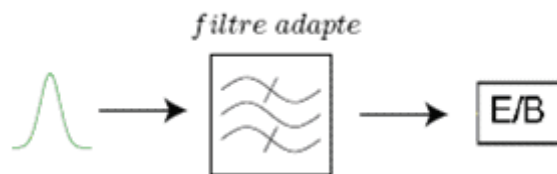
Figure 2.8 Synoptique du corrélateur
