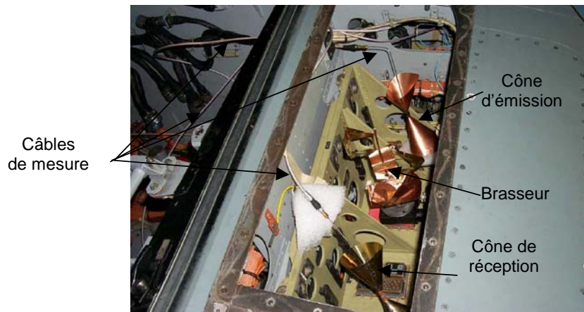
Figure III.4-4: Mesure du facteur de qualité dans la soute 1
