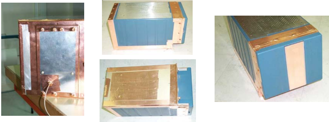
Figure III.3-8: Blindage maximal du boîtier générique
