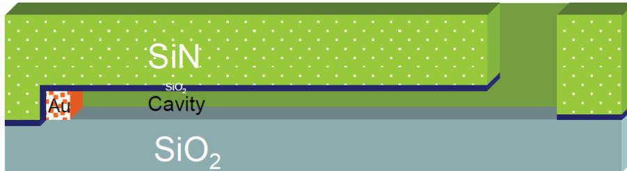
Figure III - 18 : Schéma d'une cavité vue en coupe
