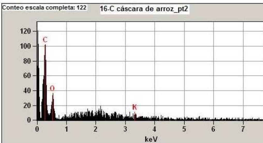
Fig. 3.17: Espectrografía de Sílice en puntos 1, y 2 en la sección transversal de la cáscara de arroz.
