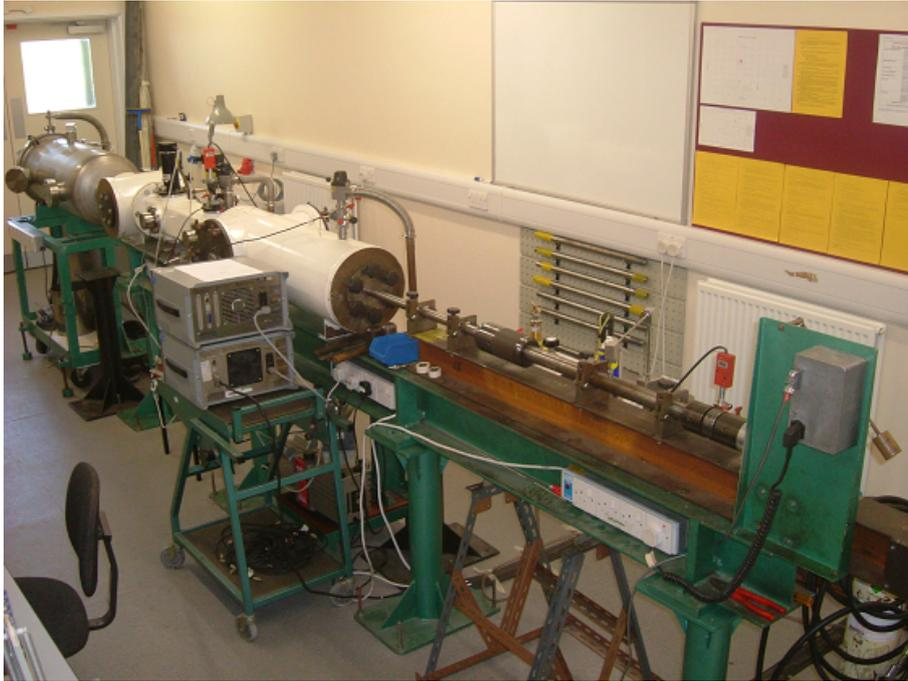
FIGURE 2.3 – Photo du canon à double étage de l’université du Kent (UK)
