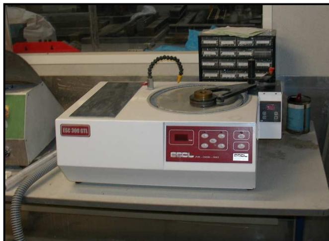
Figure 2.16. Polisseuse utilisée pour traiter la surface des échantillons préalablement de l'essai de micro-indentation
