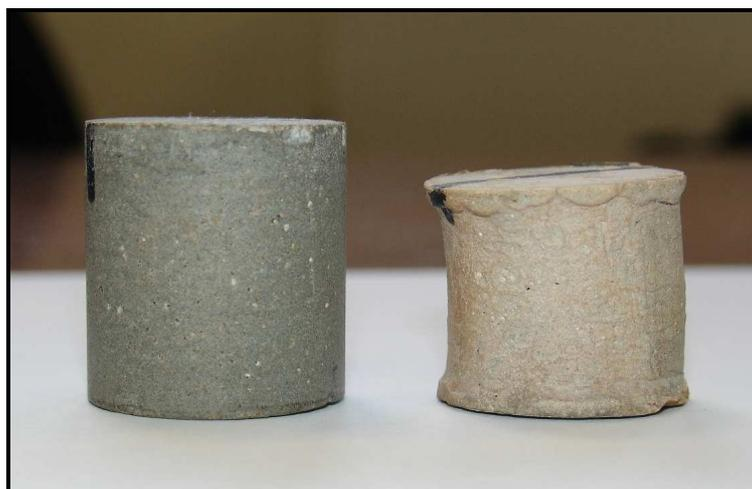
Figure 4.43. Déformations remarquées sur un échantillon totalement lixivié après avoir soumis à un essai triaxial à 20 MPa de confinement
