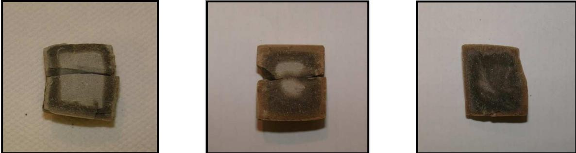
*Figure 4.1. Échantillons carbonatés puis lixiviés par le nitrate d'ammonium à 3,6 et 10 mm respectivement.*
