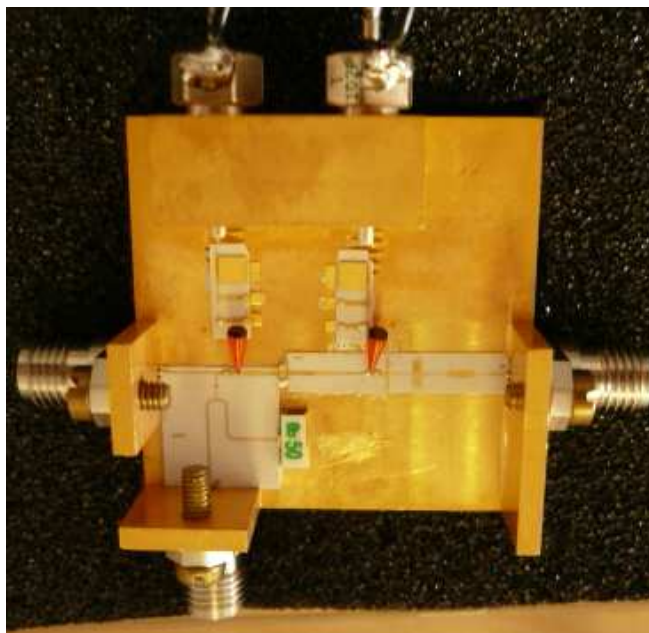
Figure III-47 : Mélangeur de type « chaud » basé sur un transistor GaN de la couche AEC1321
