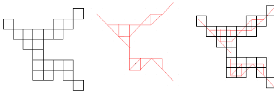
Figure 34 : A gauche le volume initial, au centre l'arbre de Dijkstra correspondant et à droite la superposition des deux (Illustration d'un cas 2D)
