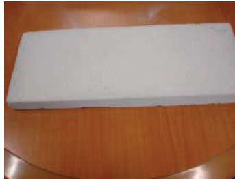
(b) béton cellulaire (50×60× 4.8 cm 3 )
