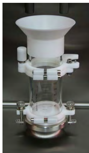
Figure B.8. La cuve de clivage (160 mL) pour le test dynamique
