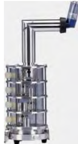
Appareil C. Impacteur à cascade Multi-étages
