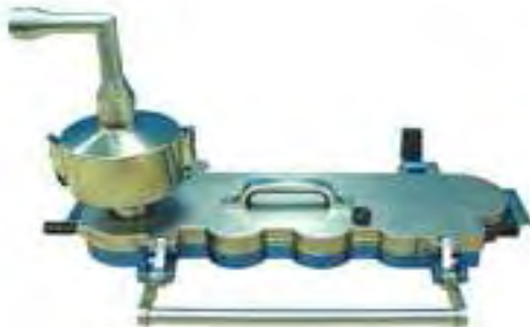
Appareil D. Impacteur à cascade Multi-étages
