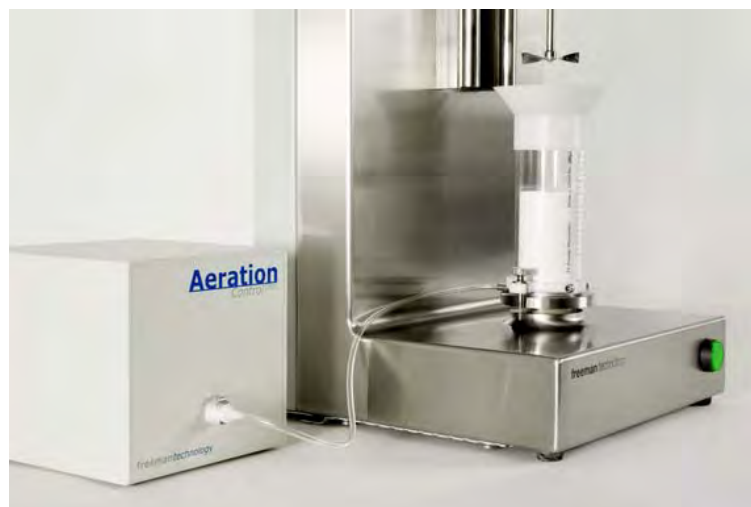
Figure B.13. Installation d'un test d'aération
