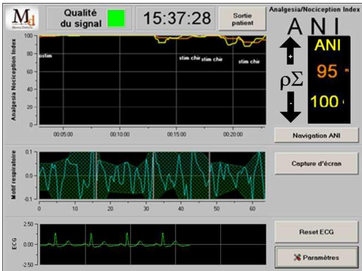
Figure 31 : interface du moniteur Metrodoloris affichant : ANI instantané en jaune; ANI moyenné sur 4 minutes en orange.
