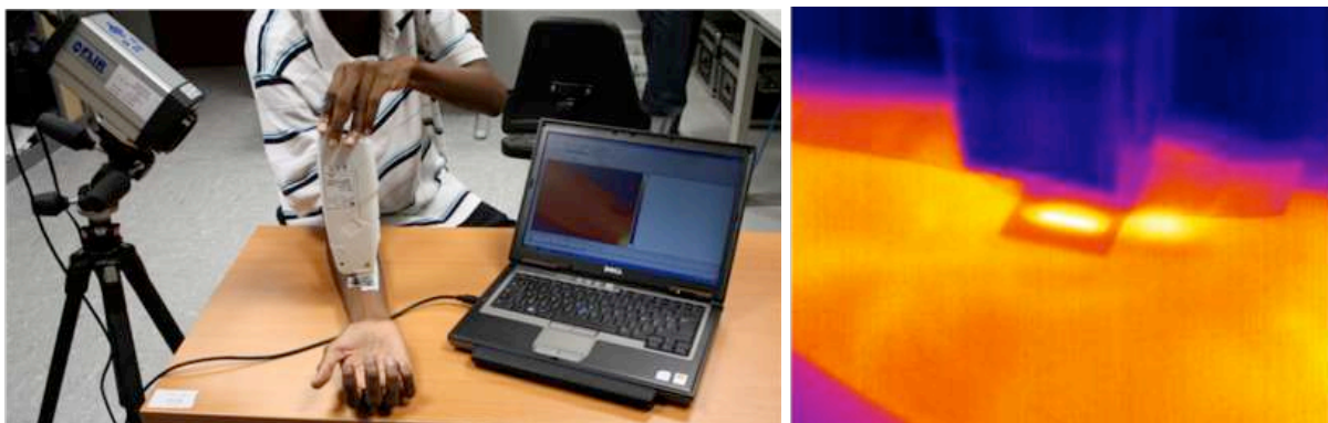
Figure 2.21 : caméra thermique, image générée par le logiciel
