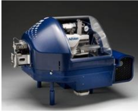
Figure 74 : Instrumentation Triversa Nanomate d'Advion permettant le LESA
