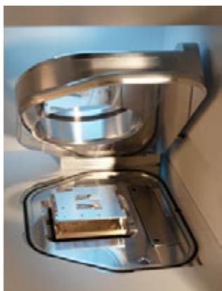
Fig. 25 : Porte-échantillons de l'XPS\_K-ALPHA placé dans la chambre d'insertion
