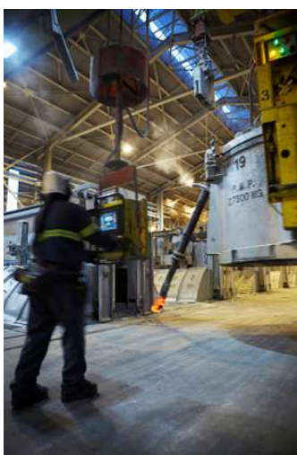
Figure 25 : Opération de pompage de l'aluminium liquide dans le bain
