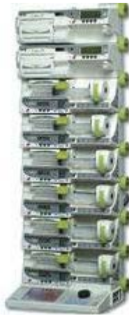
Figure 11 : Station de perfusion Orchestra, Fresenius Vial. Les deux modules du haut correspondent à des pompes volumétriques, tandis que les six modules du bas correspondent à des pousse-seringues électriques
