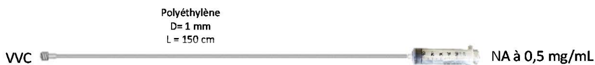
Figure 37 : Montage standard simple voie de noradrénaline
