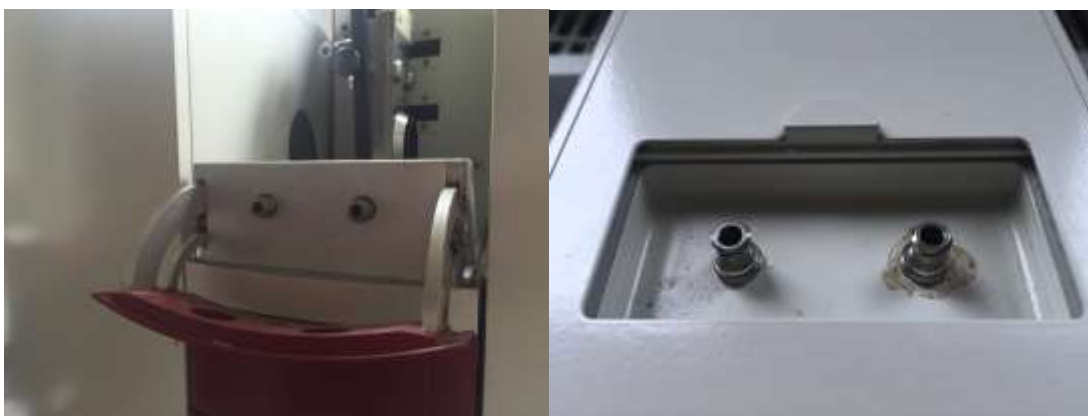
Figure 33. Présentation des embouts Luer-lock situés au niveau du système d'analyse particulaire Qicpic®.
