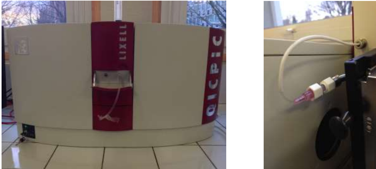
Figure 57. Granulomètre Qicpic® avec système de dispersion LIXELL (à gauche). Cathéter Broviac® directement connecté au système d'analyse Qicpic® (à droite).
