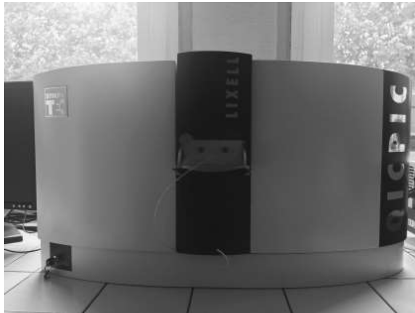
Figure 32. Présentation du système d'analyse particulaire Qicpic® (Sympatec GmbH, Clausthal-Zellerfeld).
